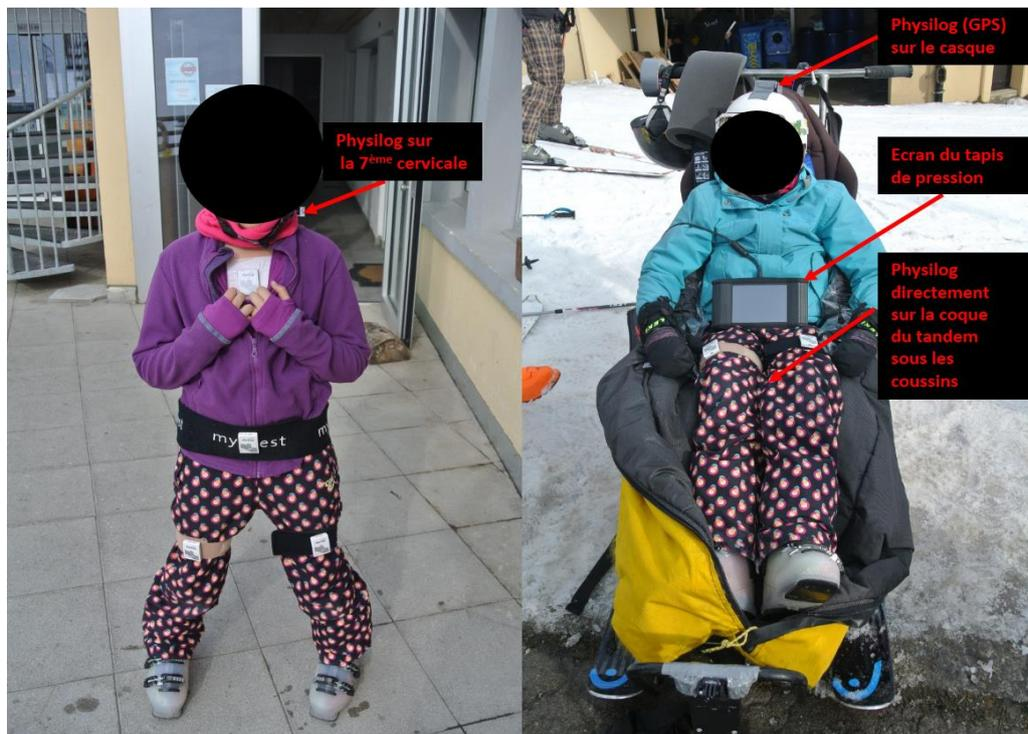
Figure 3 : positions des différents capteurs
