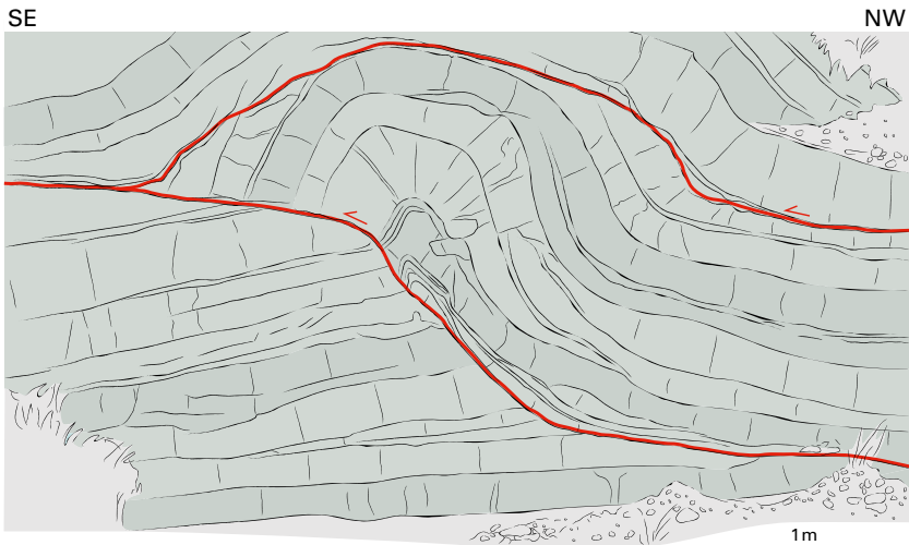
Fig. 43: Petit pli de nature fault-propagation fold avec breakthrough dans la Formation du Pichoux au sud-ouest du lac de Moron (coord. 2546.075/1215.630). Une série de plis subordonnés documente la problématique de l'espace sous la grande voûte de la Formation de Reuchenette dans l'anticlinal du lac de Moron. D'après un dessin de U. Eichenberger.
