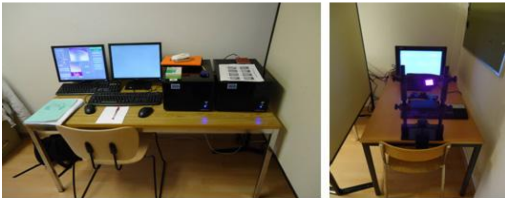
Figure 13 : Photographies du dispositif expérimental. A droite, l'emplacement du participant avec le dispositif d' eye-tracking . A gauche, l'emplacement de l'expérimentateur, avec les deux moniteurs de contrôle, un pour le dispositif d'enregistrement des mouvements de poursuites oculaires et un pour suivre les stimuli perçus par le participant.
