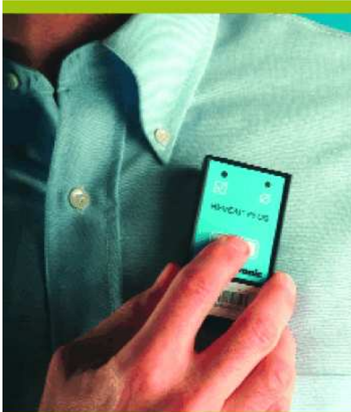
Figure 2. Cette photo représente l'activateur externe tel qu'il doit être positionné en regard du moniteur ECG implantable (MEI) pour permettre la mise en mémoire d'un épisode
