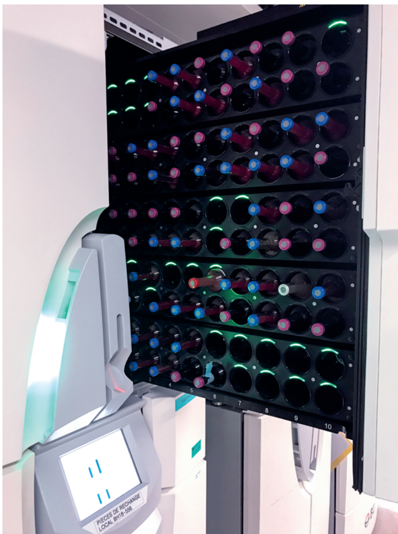
Figure 1: Exemple de système d'incubation des bouteilles d'hémocultures.
