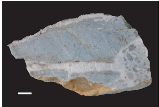
Figure 2.11: Rhyolite recoupée par une brèche hydrothermale quartzeuse et uranifère. Indice de Gré Delley, Morcles (VD). MGL58096. Echelle: 1 cm.
