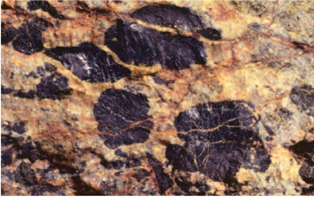
Figure 4.20: Sphérolites d'uraninite lardés de veines de vandendrieschélite et d'uranophane- $\alpha$ . Travaux de surface Juillard, mine de La Creusaz, Les Marécottes (VS). Coll. S. Ansermet. Longueur réelle de l'image: 2 cm.
