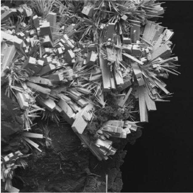
Figure 4.12: Uranophane-β en lattes et uraniumophane-α en aiguilles. Indice de Balayé, Finhaut-Emosson (VS). Cliché SEM/BSE. Longueur réelle de l'image: 2,2 mm.
