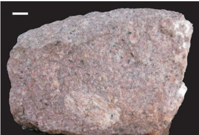
Figure 2.10: Microgranite rubéfié à phénocrystal d'orthoclase. Combe de la Golette, Salanfe (VS). MGL58143. Echelle: 1 cm.
