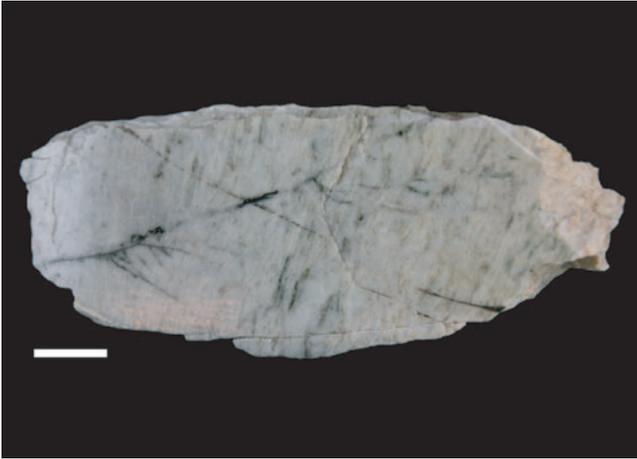
Figure 2.8: Leptynite encaissant les brèches uranifères. Travaux de surface Gisiger, mine de La Creusaz, Les Marécottes (VS). MGL58328. Echelle: 1 cm.
