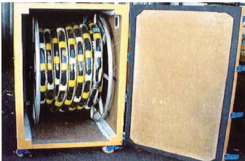
FIG. 3.9: Flûte mise dans un caisson isolant pour l'étalonnage des hydrophones selon la technique de Teledyne (Streamer section calibrator).
