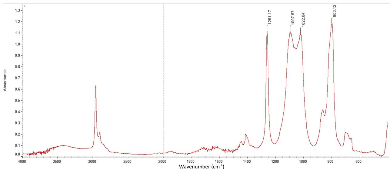
Fig. 2. : Illustration of a reference PDMS spectrum analysed using DRIFTS.
