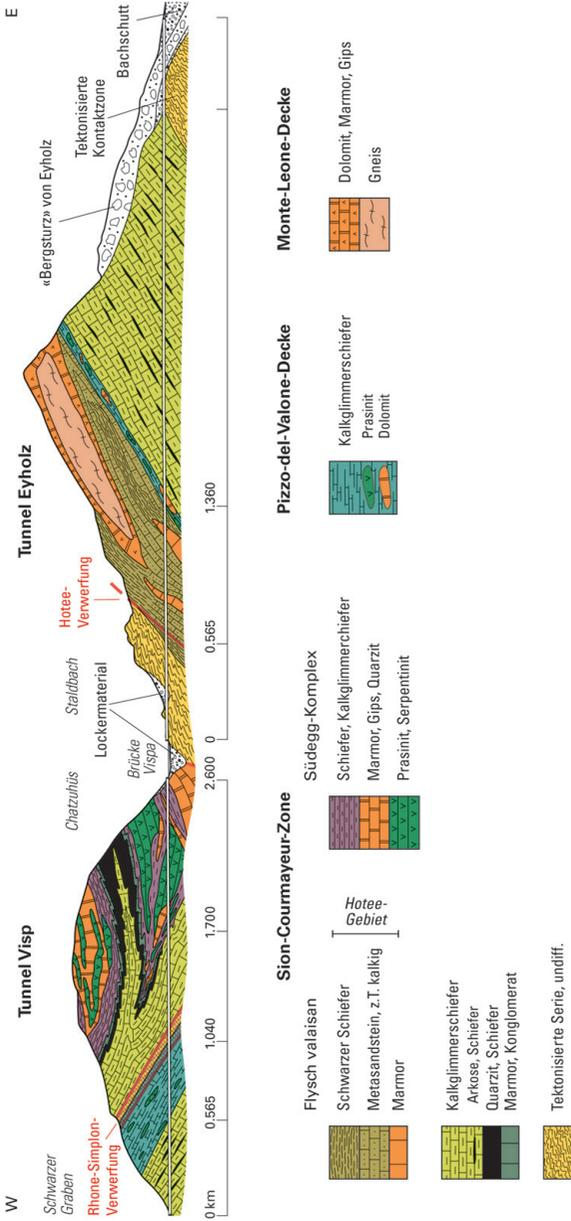
Fig. 16: Geologisches Profil entlang der Trasse der beiden Tunnels der Autobahn A9 südlich von Visp. Quelle: Bureau Norbert SA, Martigny.
