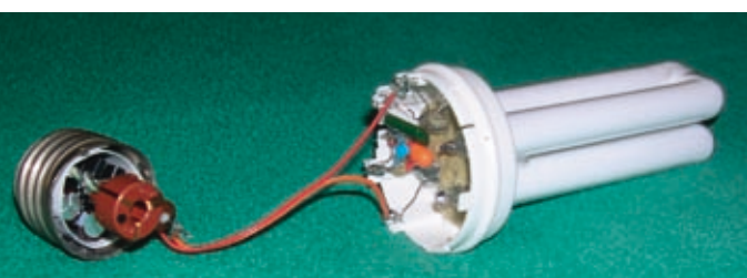
Erster Prototyp eines neu entwickelten 11-W-Vorschaltgerätes
