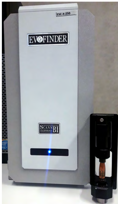
Figure 22: En haut: Photo illustrative du système EVOFINDER utilisé dans le cadre de cette recherche. En bas: Porte-pièce du système EVOFINDER
