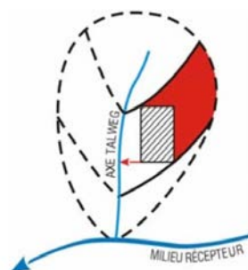
Figure 2. Notion de surface de projet (en hachuré) augmentée du bassin versant dont les écoulements sont interceptés par le projet (en rouge) (source : Préfecture d'Indre-et-Loire, 2008, p. 22)
