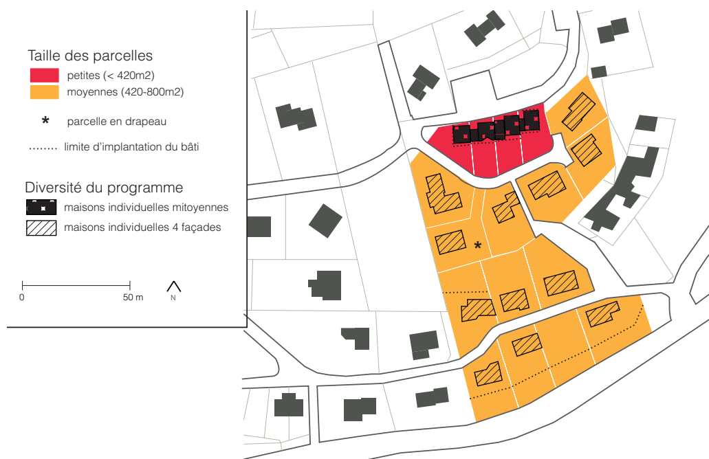
Figure 72. Trame parcellaire du Jardin de Rampeaux : des petites parcelles étroites en lots libres, une diversification pour la fabrique ordinaire de la ville (source : dossier de demande de permis de lotir ; cartographie : L. Herrmann, 2016)
