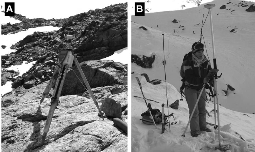
**Fig. II.34** – Antenne GPS de base fixe (A) et antenne GPS mobile permettant d'effectuer les mesures sur le terrain, vallon des Yettes Condjà (versant est du Mont Gelé).
