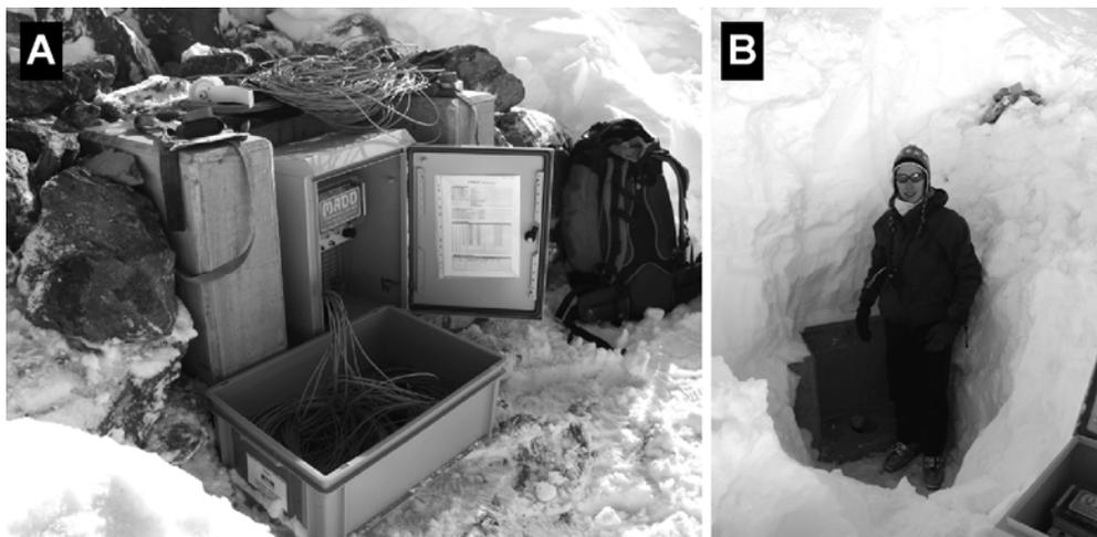
**Fig. II.11** – Installation de capteurs de température de type MADD dans le forage 2/2008 aux Attelas (A) (10.11.2008) et dans le forage 12/2008 aux Lapires (B) (12.01.2009).
