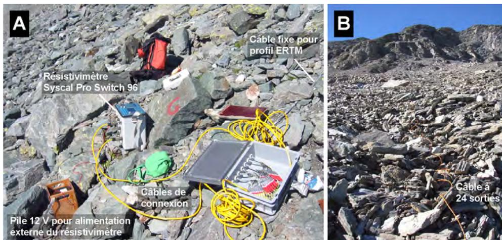
**Fig. II.19** – (A) Emplacement de mesure du profil ERTM fixe sur l'éboulis des Attelas, avec le matériel utilisé. (B) Câble à 24 sorties pour profil ERT sur l'éboulis de Tsaté-Moiry.
