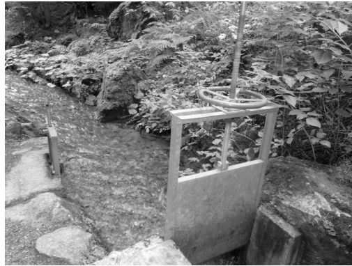
Ecluse de dérivation vers une décharge secondaire
