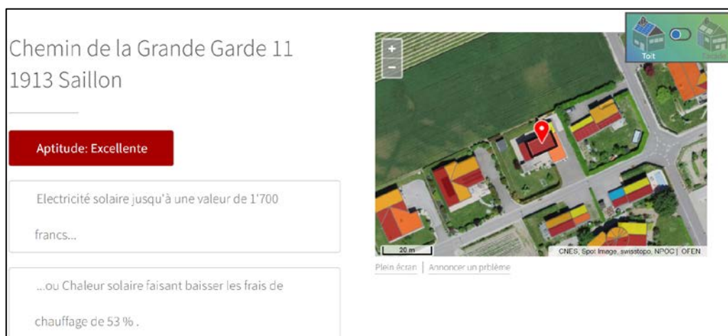
Figure 1: Exemple de l'aptitude d'un toit pour produire de l'énergie PV selon les informations en open data (www.toitsolaire.ch)
