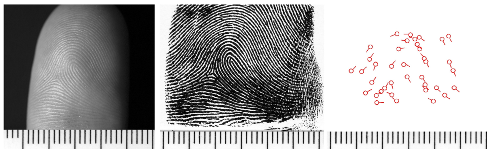
Fig. 5.1 - À gauche: matrice. Au milieu: impression digitale encrée. À droite: exemple de gabarit (les cercles indiquent les positions, les segments les directions).
