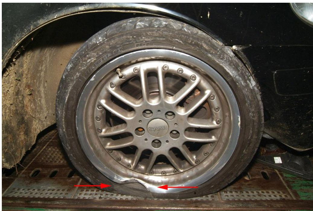
Figure 93 : Pneumatique avant droit, mise en évidence du choc contre la jante.
