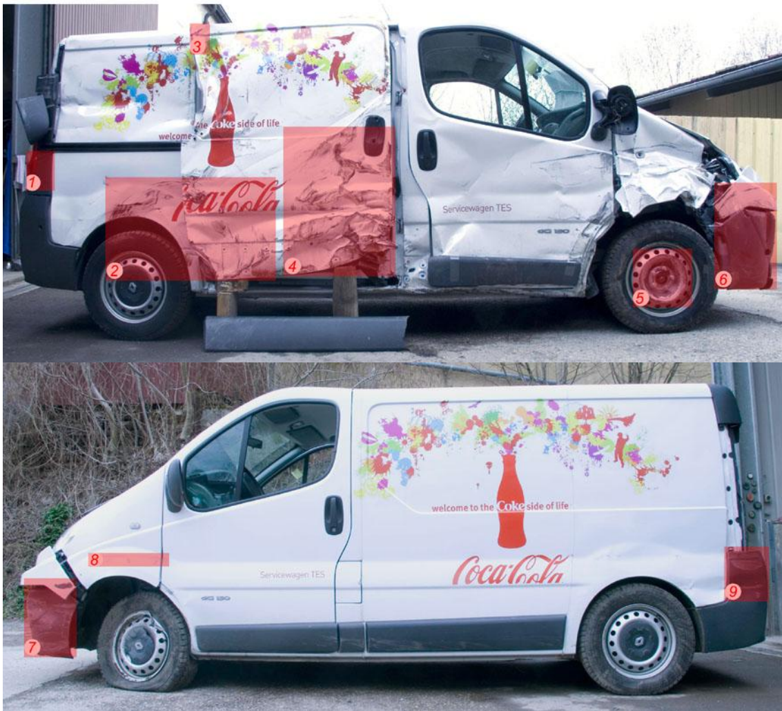
Figure 45 : Zones des prélèvements sur la camionnette Renault Trafic.
