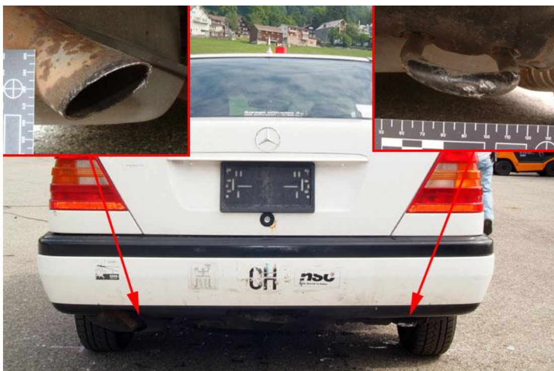
Figure 69 : position du pot d'échappement et du crochet de remorquage sur la Mercedes.
