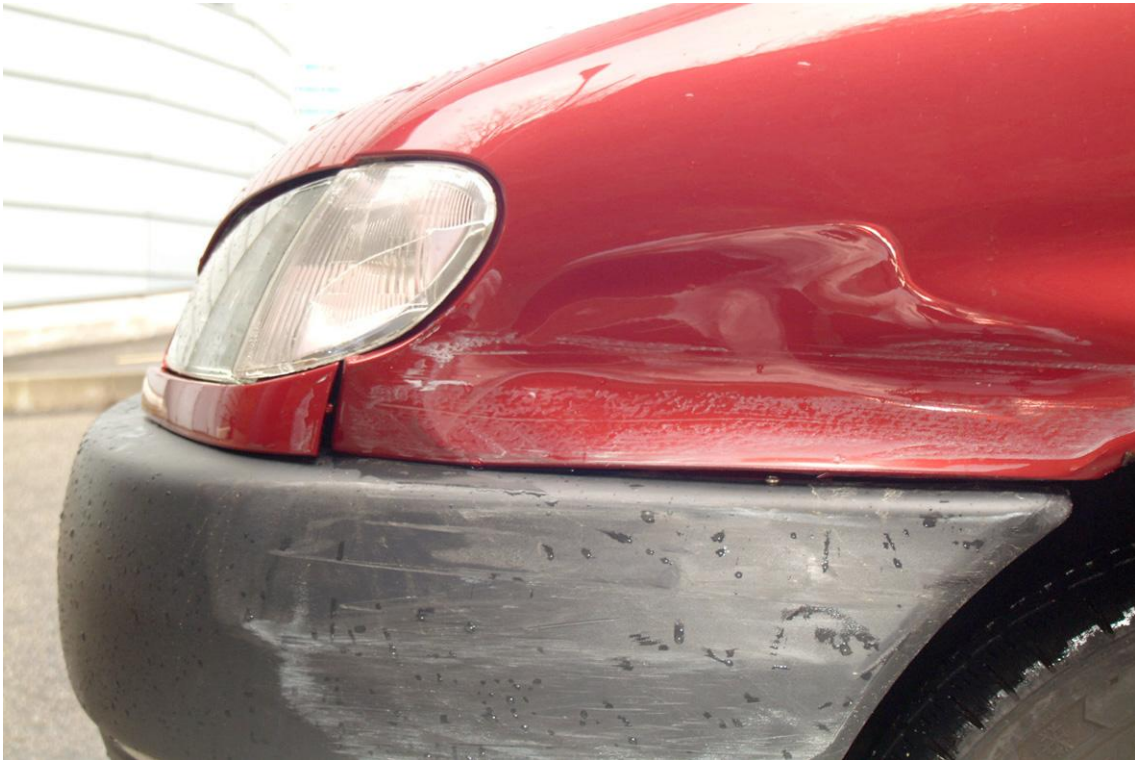
Figure 22 : Exemple d'une trace dont la déformation est définie comme étant ovale et relativement lisse.
