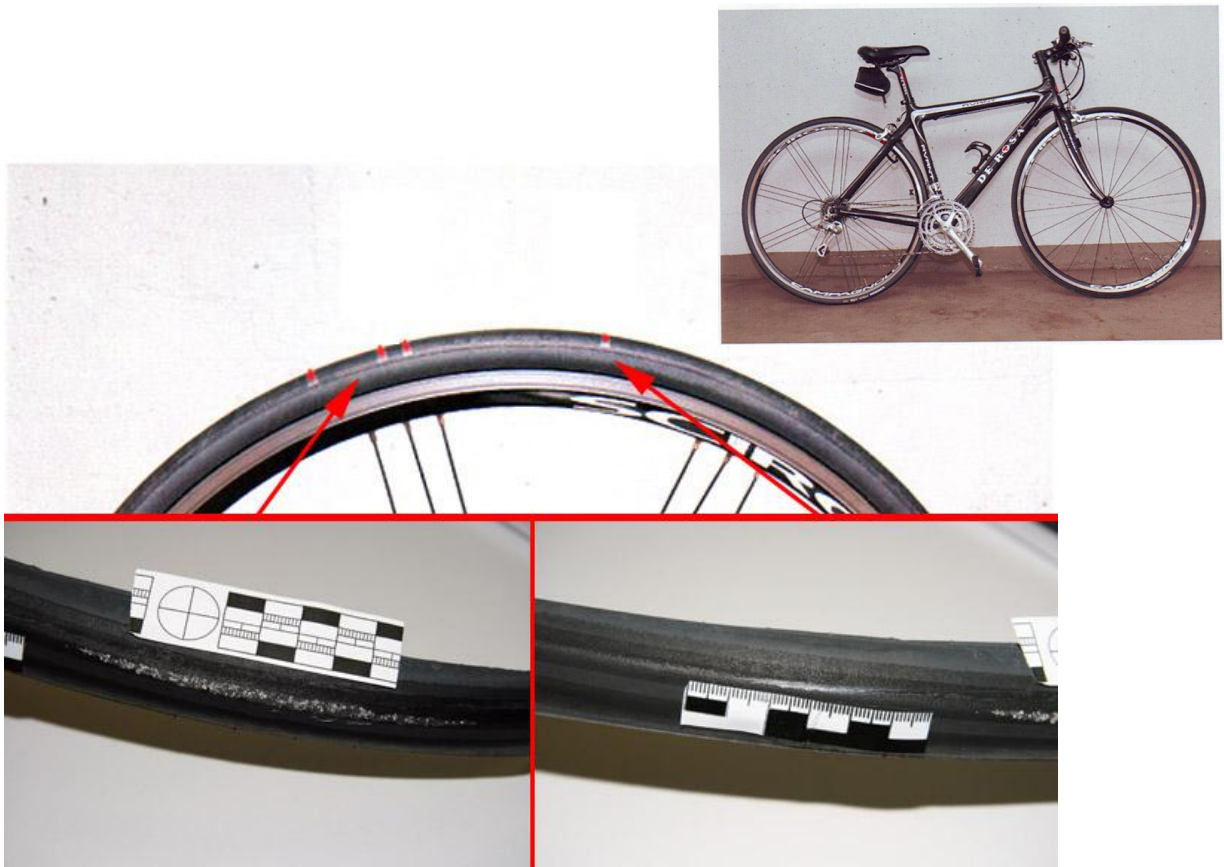
Figure 82 : Traces blanches observées sur la roue arrière du vélo.
