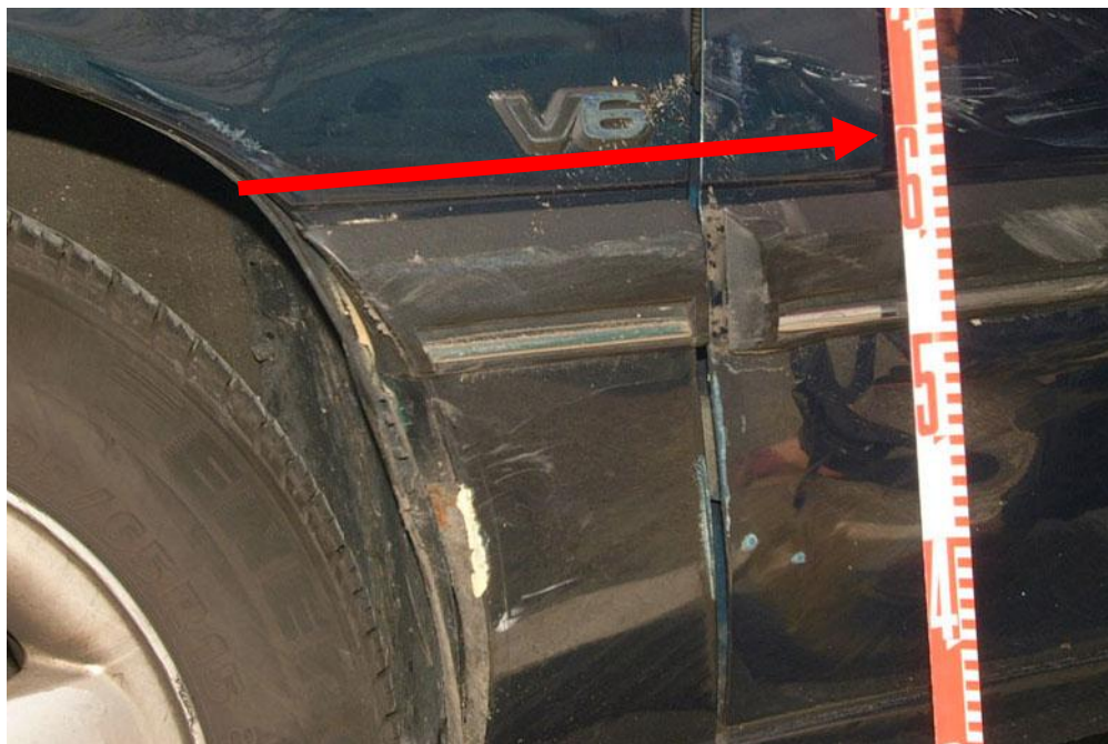
Figure 27 : Sens d'un impact déterminé en fonction des traces (2/2).
