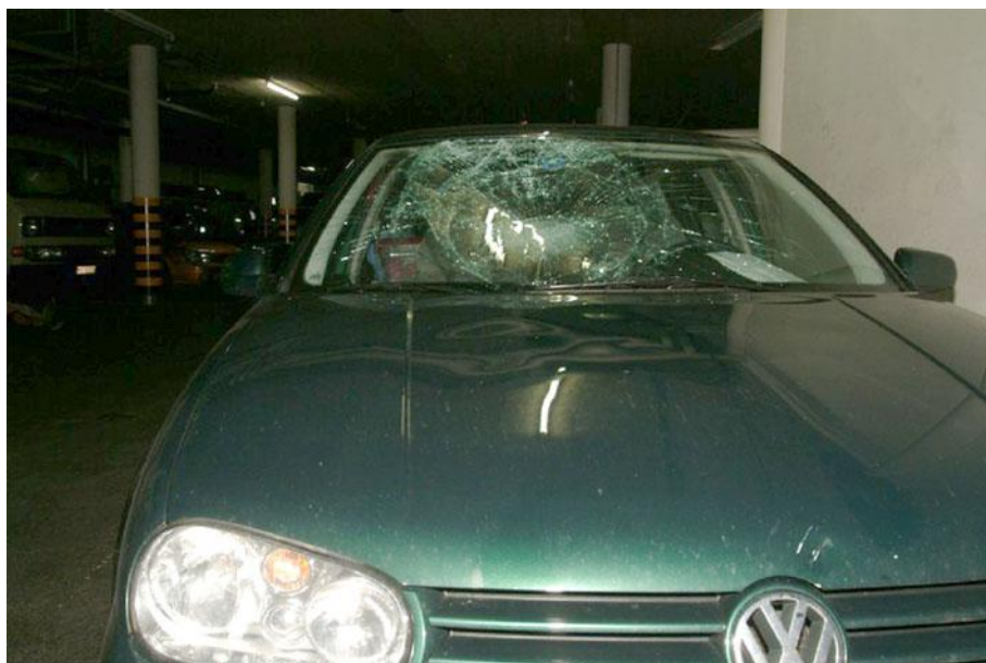
Figure 99 : Déformations sur le capot du véhicule.
