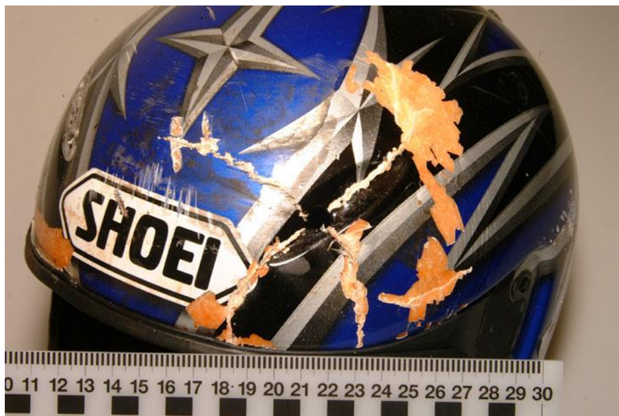
Figure 156 : Mise en évidence du revêtement appliqué sur un casque brisé.
