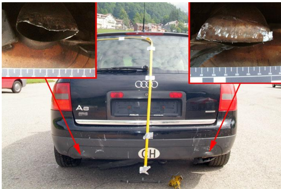
Figure 77 : vue détaillée des deux pots d'échappement de l'Audi.
