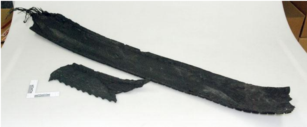
Figure 107 : Bande de roulement détachée de la jante.
