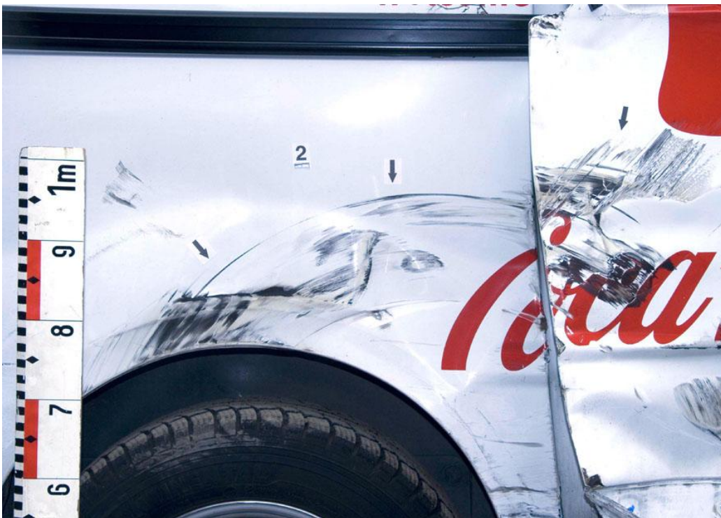
Figure 29 : Traces laissées sur un véhicule par un pneumatique en mouvement.
