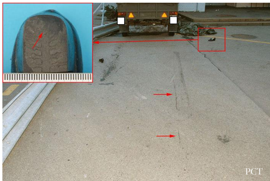
Figure 170 : Traces de gomme laissées sur le sol par les chaussures d'une victime heurtée et observation des éraflures causées par l'impact sous une des semelles (source : police cantonale du Tessin).
