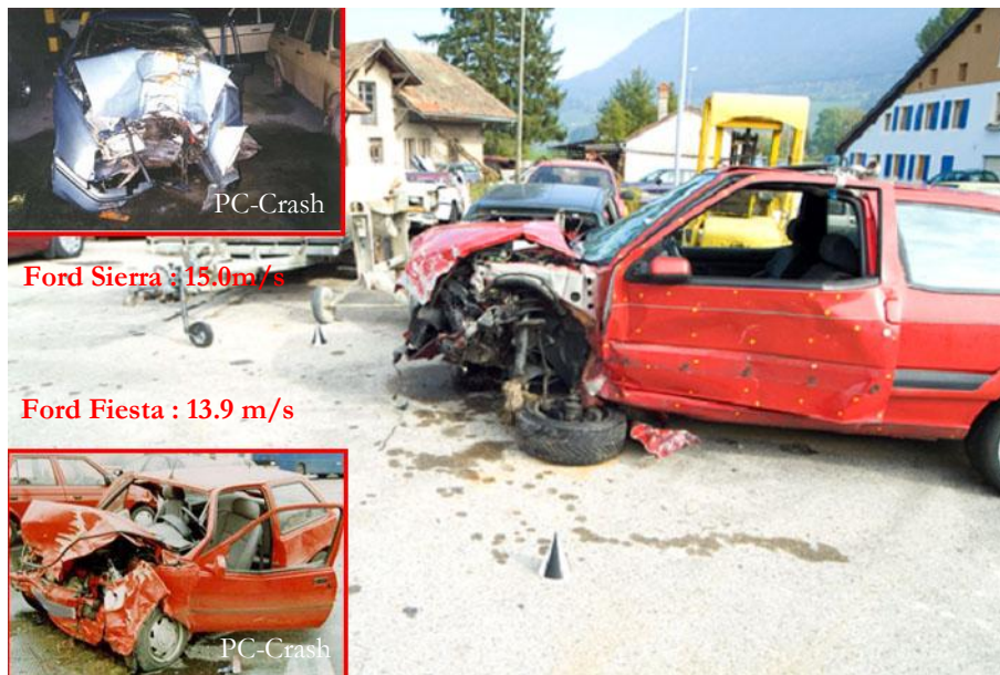
Figure 123 : Déformations sur la carcasse du véhicule et EES associés.
