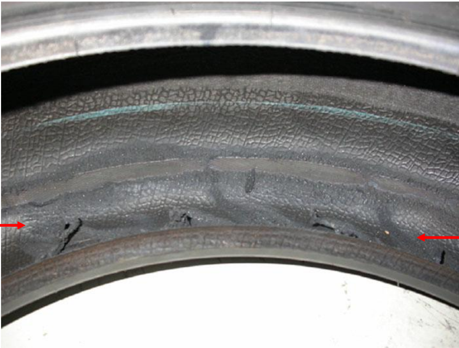
Figure 155 : Traces de fusion à l'intérieur d'un pneu éclaté par manque de pression.
