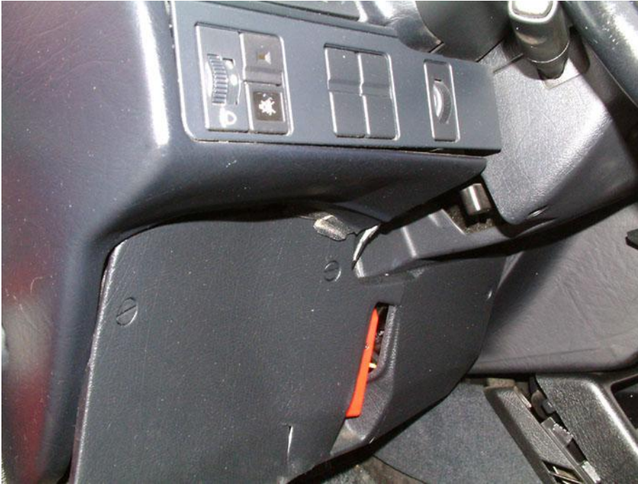
Figure 125 : Déformations constatées sous le volant suite à l'éjection du conducteur.
