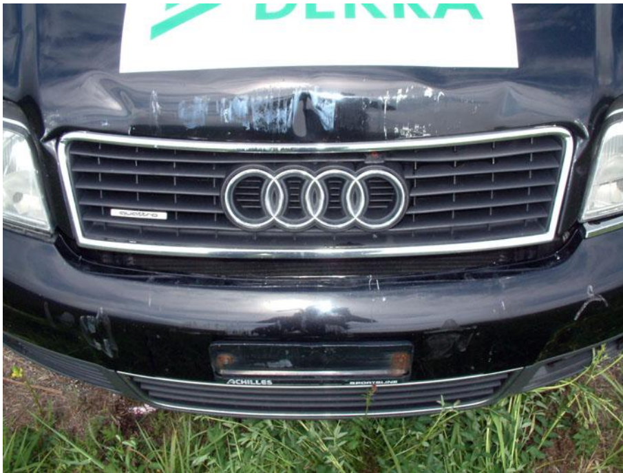
Figure 67 : Mise en évidence du transfert de peinture de la Mercedes vers l'Audi.
