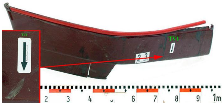
Figure 86 : Trace verte sur le pare-chocs avant du véhicule.
