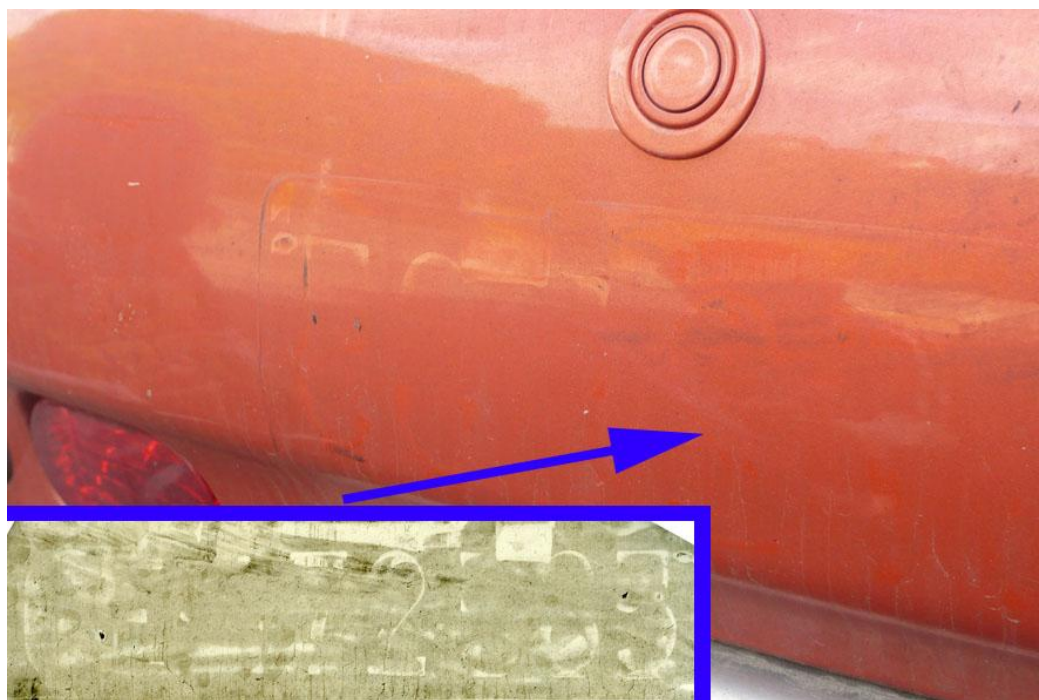
Figure 30 : Enlèvement de poussière produit par contact avec une plaque minéralogique.
