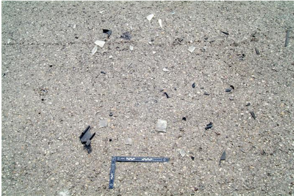
Figure 74 : débris d'optiques laissés par la Mercedes sur les lieux du crash-test.
