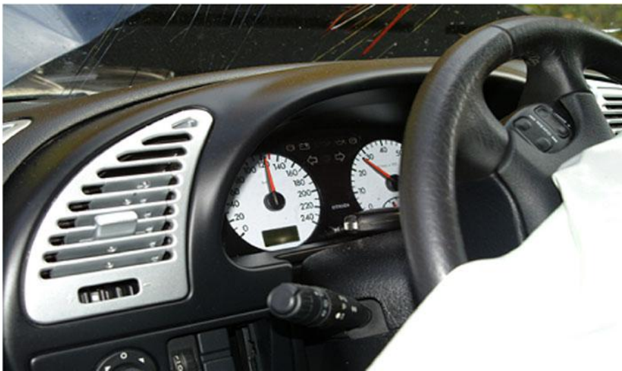
Figure 182 : Compteur bloqué à la suite d'un impact.
