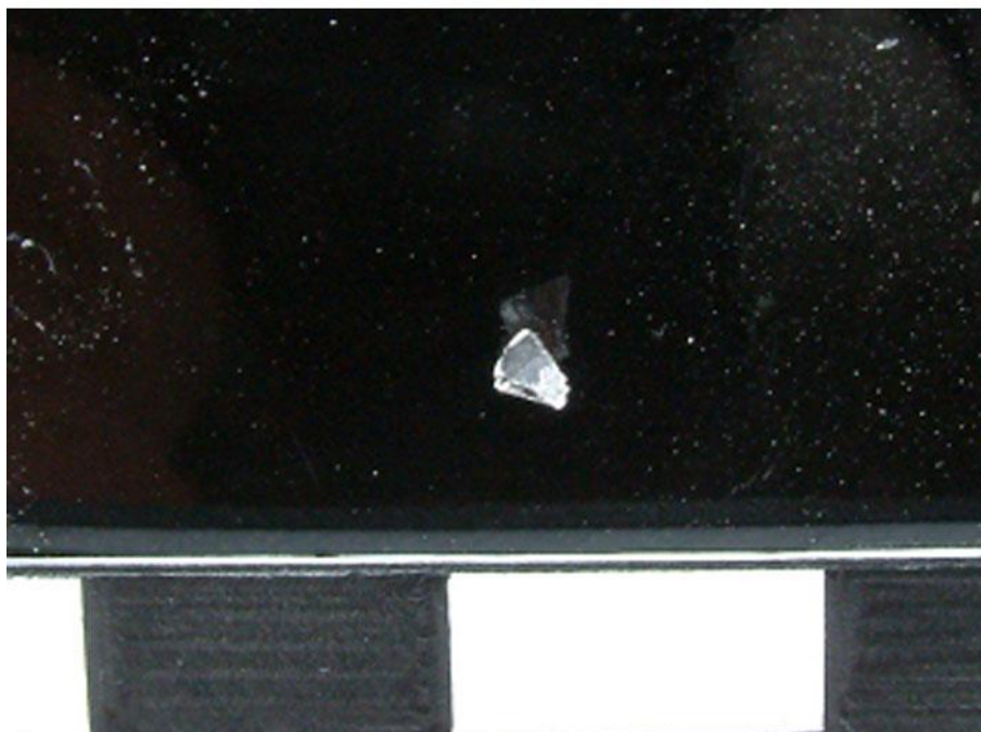
Figure 158 : Exemple d'un transfert de verre d'optique sur une carrosserie (persistance faible).
