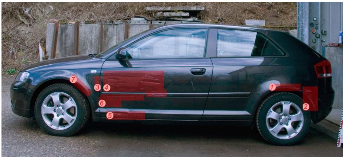
Figure 44 : Zones des prélèvements sur l'Audi A3.
