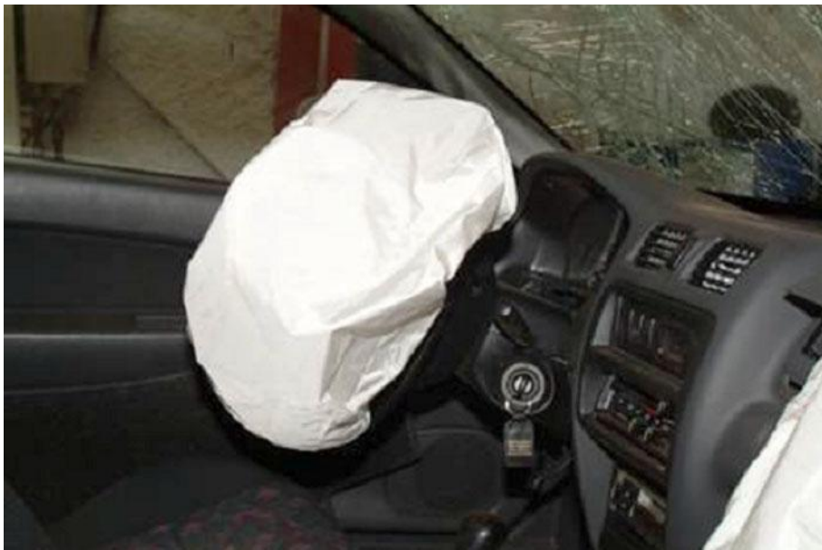
Figure 178 : Illustration d'un airbag ayant explosé.
