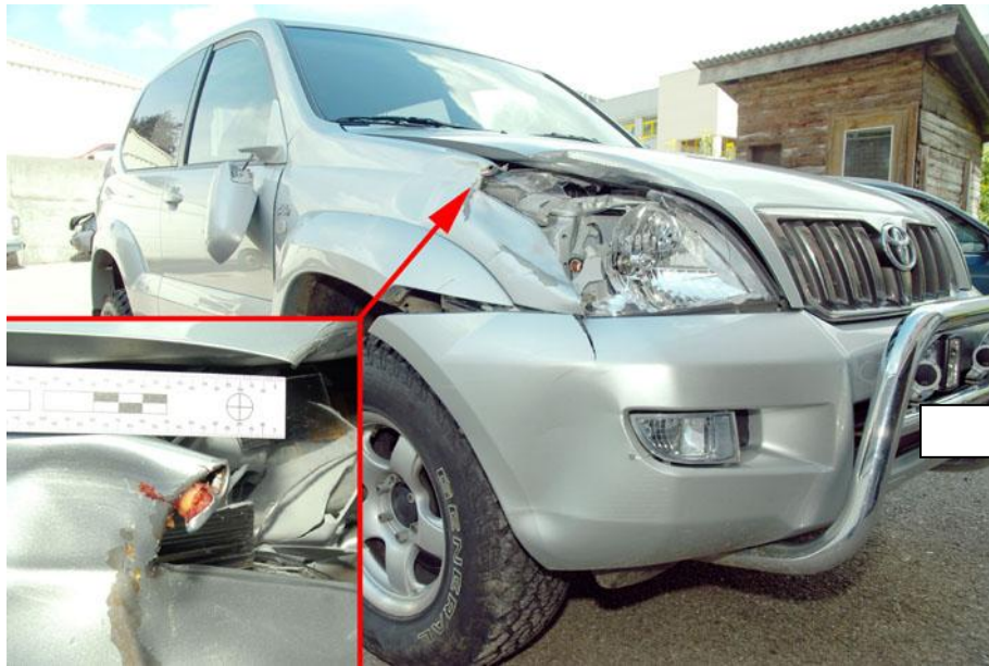
Figure 136 : Déformations sur le véhicule et traces biologiques provenant du cycliste de derrière.
