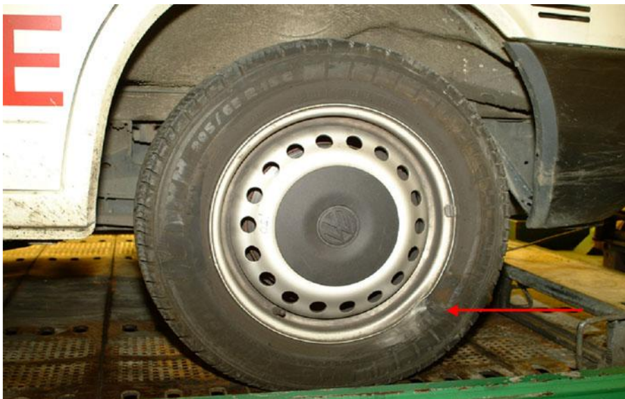
Figure 153 : Déformation constatée sur une jante suite à un choc.
