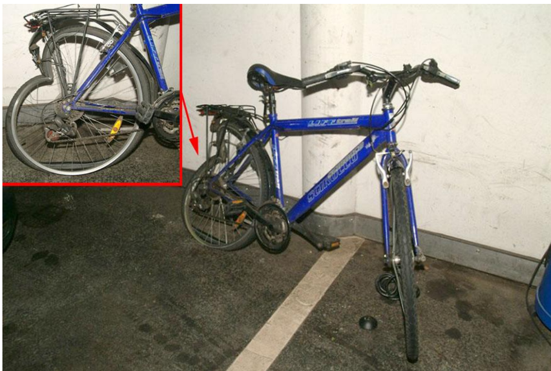
Figure 101 : Examen du cycle et des déformations.
