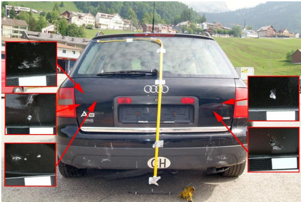
Figure 75 : débris de verre sur l'arrière de l'Audi.
