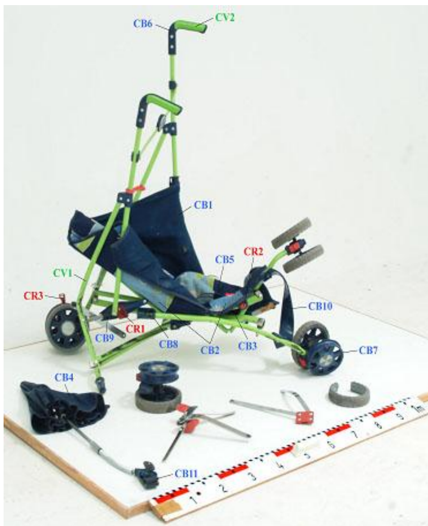
Figure 88 : prélèvements de comparaison sur le pousse-pousse heurté par le véhicule.
