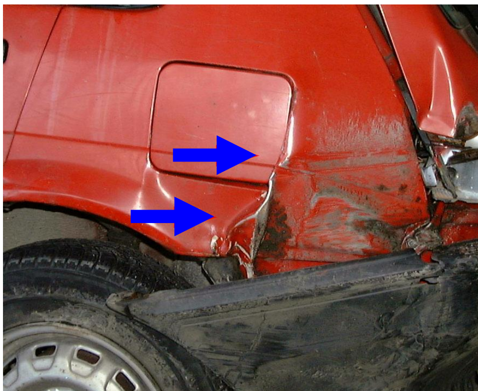
Figure 35 : Détachement de la peinture dans les zones où la tôle est fortement déformée (angle aigu) – 2/3.
