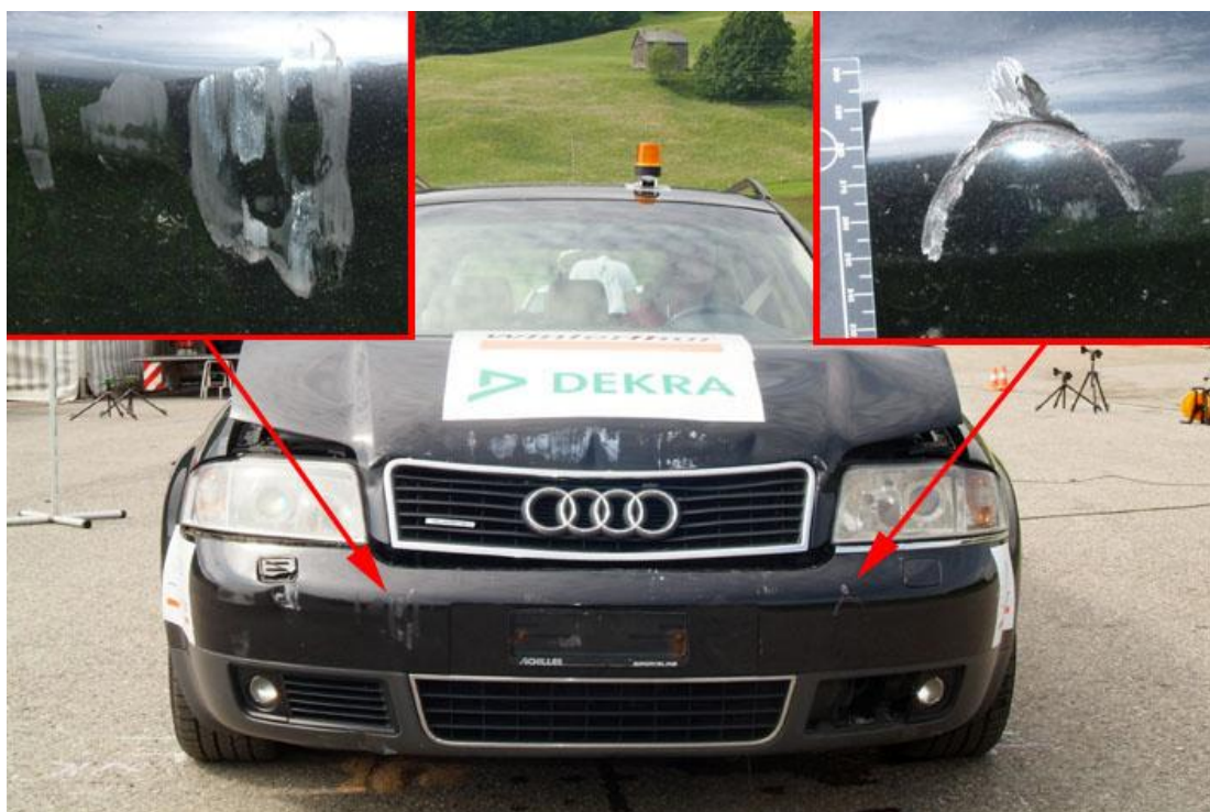
Figure 68 : traces du pot d'échappement et du crochet de remorquage de la Mercedes.
