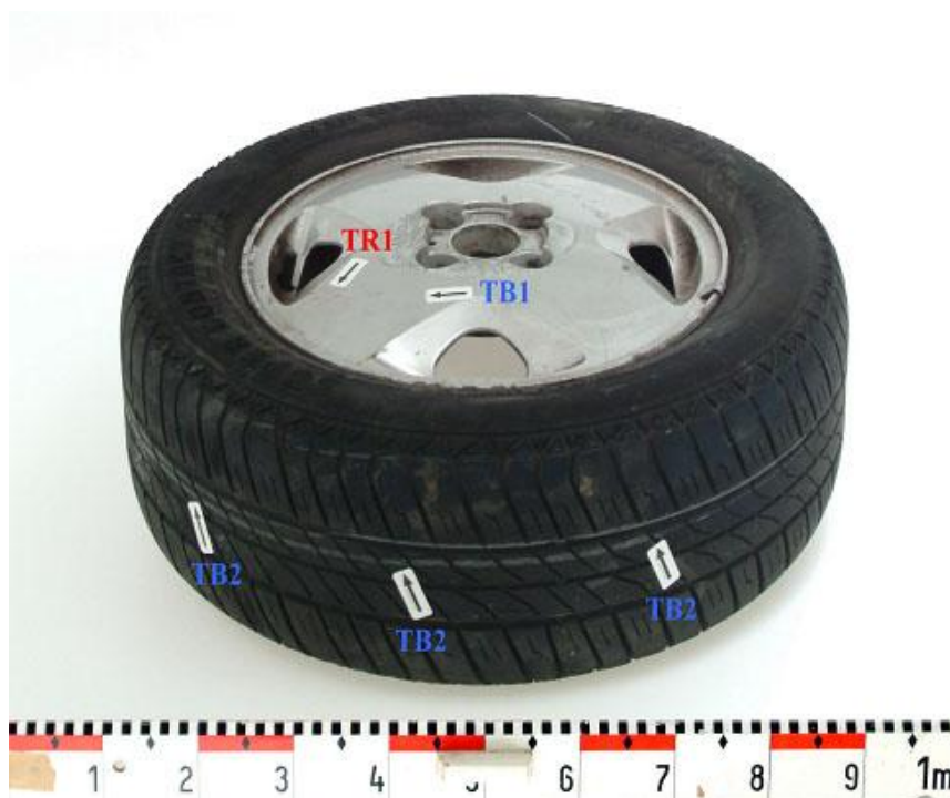
Figure 87 : Traces bleues (2 types) et rouges sur le pneumatique avant droit.
