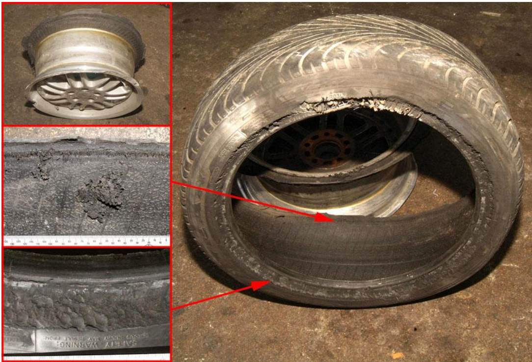
Figure 94 : Pneumatique arrière droit, mise en évidence des traces d'échauffement.
