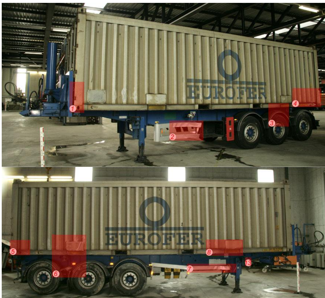
Figure 47 : Zones des prélèvements sur la semi-remorque Van Hool.
