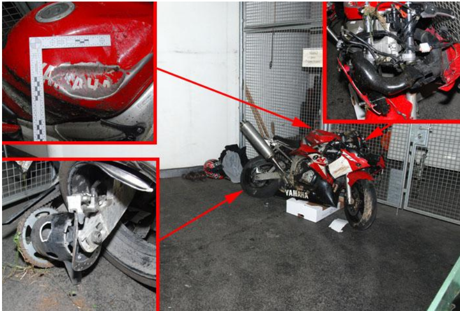
Figure 115 : Déformations constatées sur la moto. Concordances avec les 3 impacts sur les lieux.
