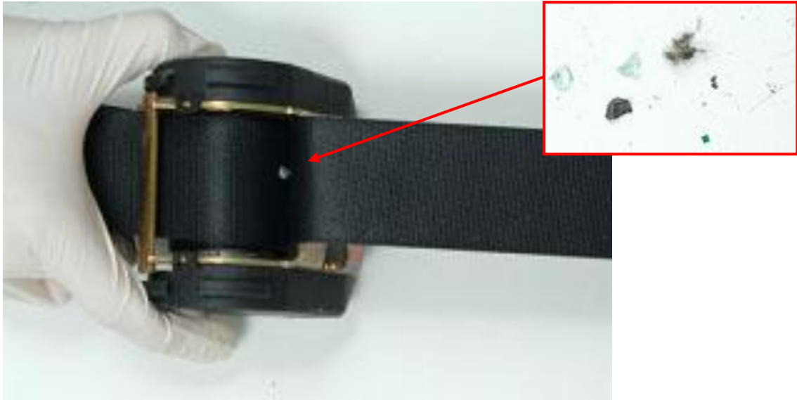
Figure 91 : Fragments de verre retrouvés dans la sangle enroulée, du côté conducteur.
