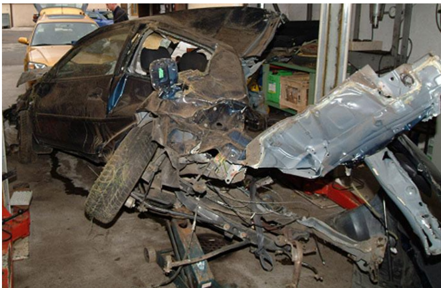
Figure 143 : Exemple de déformation nécessitant l'utilisation de la photogrammétrie.
