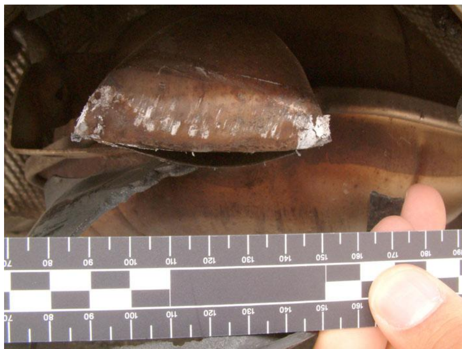
Figure 38 : Exemple de transfert de peinture sur un pot d'échappement chaud.
