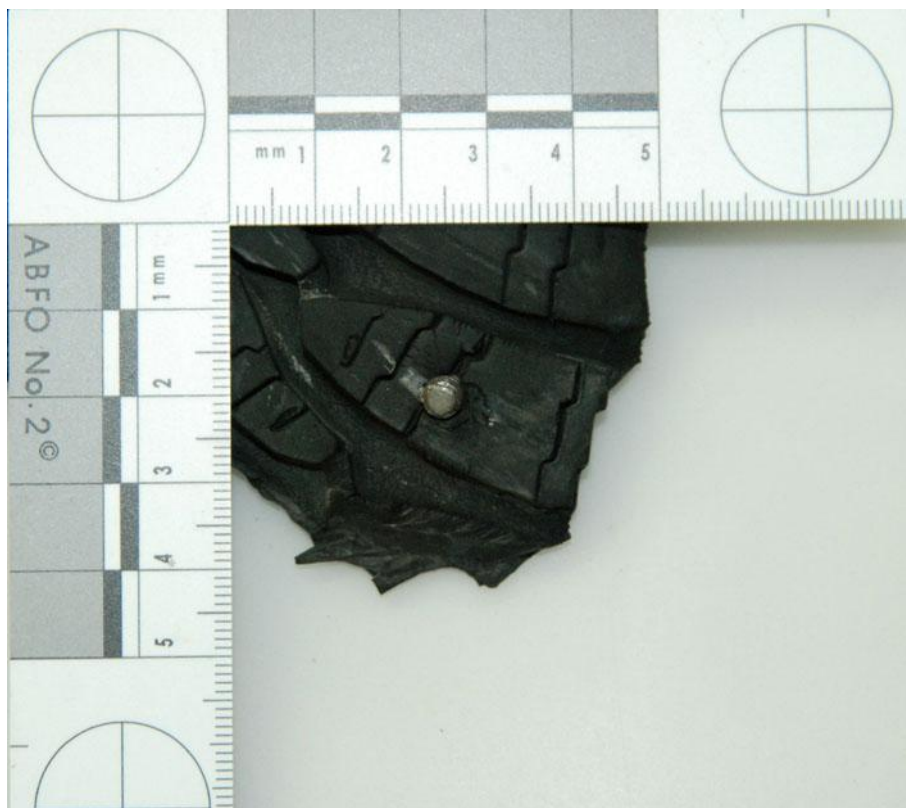
Figure 108 : Vis retrouvée dans la bande de roulement du pneumatique arrière droit.
