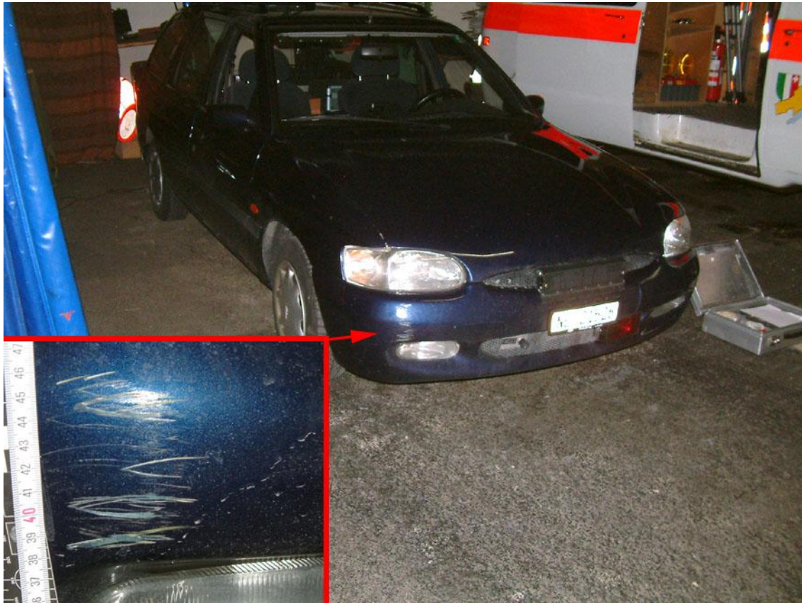
Figure 95 : dégâts observés sur la partie avant droite du pare-chocs.
