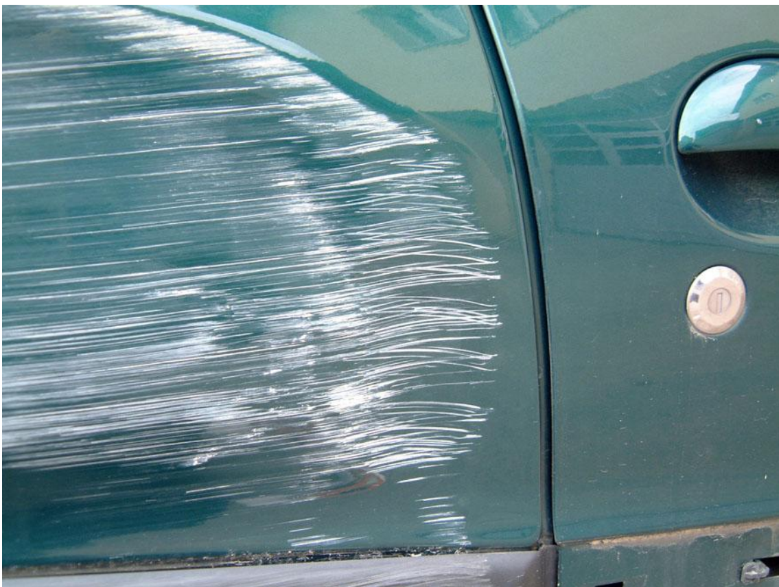
Figure 23 : Exemple d'une trace dont la déformation est définie comme étant ovale et de texture griffée.
