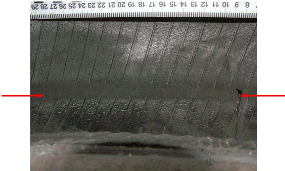
Figure 128 : Traces caractéristiques indiquant une sous-pression dans le pneumatique.
