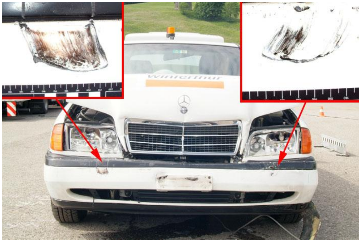
Figure 76 : Traces des pots d'échappement de l'Audi sur l'avant de la Mercedes.
