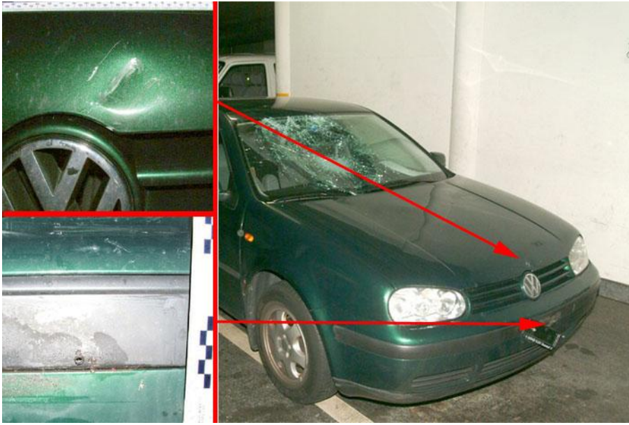
Figure 100 : Mise en évidence de traces de contact avec un objet dur (haut) et traces de plastique rouge brisé (bas).
