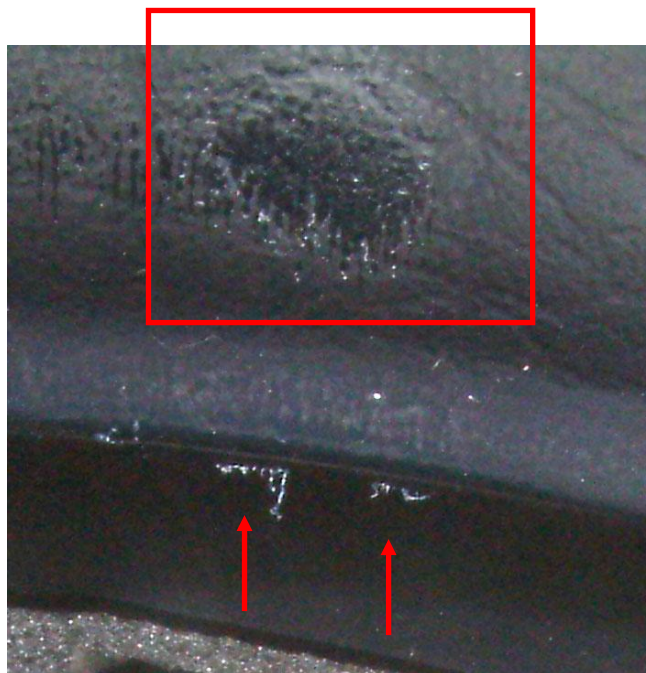
Figure 162 : Fibres fondues sur un revêtement plastique de l'habitacle (sous le volant).
