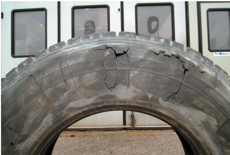
Figure 127 : Craquelures observées sur les flans du pneu déjanté.
