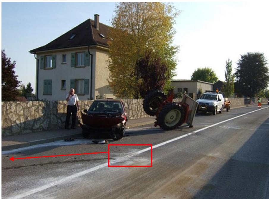
Figure 160 : Traces d'écoulement laissées par l'avant du tracteur, arraché (flèche rouge). Le cadre rouge montre la zone d'impact (giclures recouvertes de sable par les premiers intervenants).
