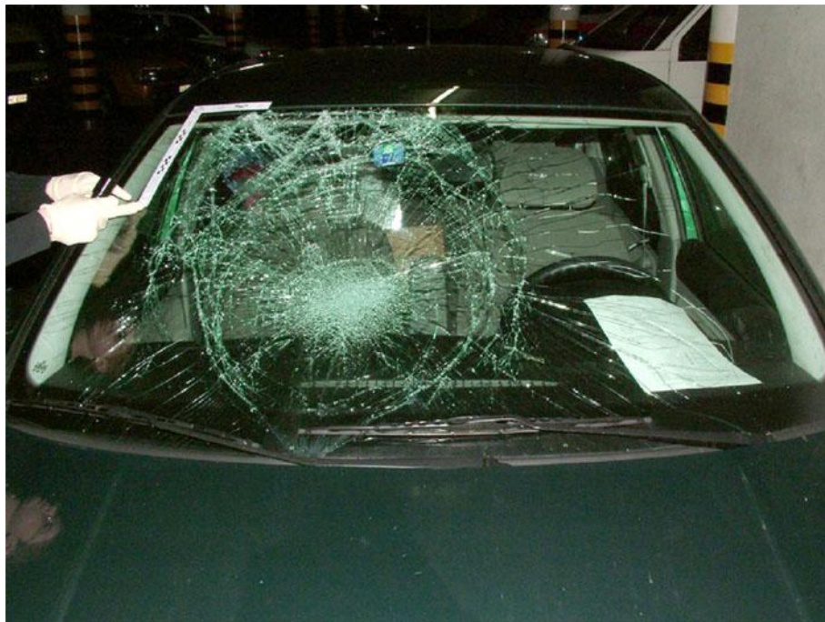
Figure 98 : Dégâts observés sur le pare-brise du véhicule VW Golf.
