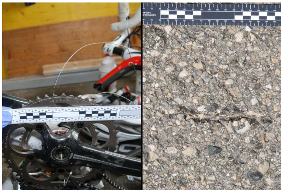
Figure 134 : Abrasions sur le pédalier du cycle de queue de file et trace creuse sur la chaussée.
