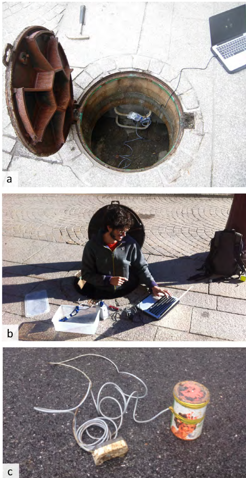
FIGURE 3.30 – Datalogger (modèle d'intérieur) protégé par une pochette plastique, provisoirement installé dans un regard suite à la panne d'un Hobo-Station (a). Ré-installation d'un logger Hobo-Station, mis à l'abri de la condensation dans une boîte en plastique (b). Bricolage inventé par le fontainier communal pour remplacer un logueur Hobo-Station défectueux par un logueur Hobo d'intérieur (c).
