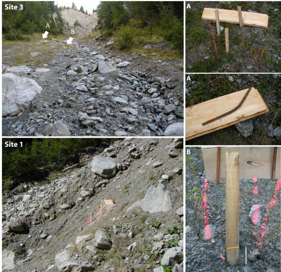
**Figure 8.5** Installation de piquets permettant de mesurer les taux d'érosion à la surface de zones de matériaux meubles. La figure en bas à gauche montre les piquets installés au front du glissement (site n°1), qui avaient disparu lors de la visite du 4 septembre. Sur le troisième site, les mouvements de terrain ont même provoqué des torsions sur les chutes de fer (A et B).
