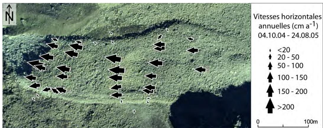
**Figure 5.16** Vitesses horizontales annuelles [cm/an] mesurées sur le glacier rocheux de Tsarmine. Tiré de Lambiel (2006).
