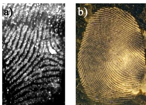
Figure 3-9 : Traces papillaires détectées à l'aide de *quantum dots* de CdSe en solution aqueuse, a) sur feuille d'aluminium, CdSe/ZnS activé par du carbodiimide (Menzel, 2001), b) sur adhésif, CdSe (Wang *et al.*, 2009).
