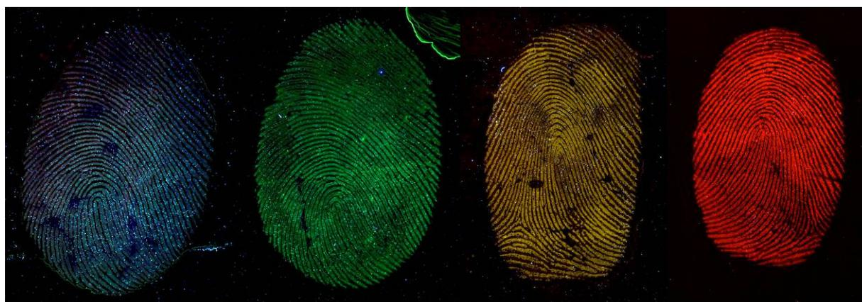
Figure 8-15 : Détection de traces papillaires sur aluminium à l'aide de nanoparticules de SiO<sub>2</sub> contenant des *quantum dots* de taille variable, permettant de faire évoluer le maximum d'émission. Les traces sont visualisées sous UV (300-400 nm), sans filtre d'observation.
