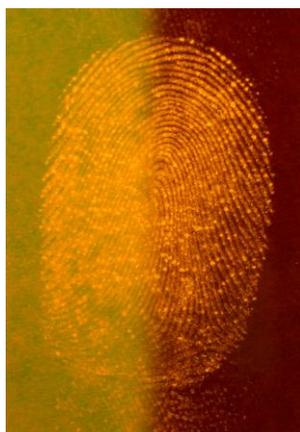
Figure 4-2 : Illustration de l'influence du filtre utilisé. Cette trace papillaire, détectée à l'1,2-indanedione/Zn sur une feuille de papier blanc, est mise en évidence par une excitation à 515 nm (Crimescope MSC-400). La moitié de gauche est visualisée avec un filtre gélatine orange (LEE filter 23A) et la moitié de droite est visualisée avec un filtre interférentiel orange (centré à 590 nm, avec une bande passante de 37 nm).
