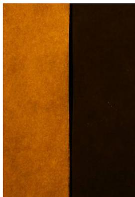
Figure 8-10 : Illustration du résultat obtenu sur surface poreuse lors de l'application d'une solution de nanoparticules de SiO<sub>2</sub> luminescentes (moitié de gauche), et sans traitement (moitié de droite).
