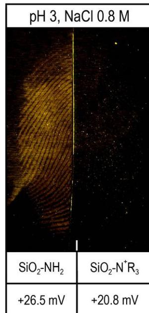
Figure 7-25 : Comparaison de l'effet d'une diminution de potentiel zêta pour des solutions de nanoparticules fonctionnalisées avec des amines primaires (à gauche) et quaternaires (à droite). Les deux solutions sont à pH 3 et contiennent une concentration en NaCl équivalente (0.8 M), pour un temps d'immersion d'une heure. Visualisation en luminescence avec une excitation à 515 nm et une observation avec un filtre interférentiel à 590 nm.
