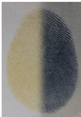
Figure B-15 : Illustration d'une trace sur du papier blanc, détectée suite à une exposition aux vapeurs d'iode (moitié gauche). La trace prend une coloration beige. Après fixation par une solution de 7,8-benzoflavone (moitié droite), la trace devient bleu foncé.
