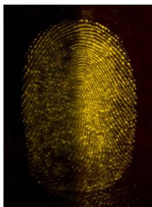
Figure B-6 : Comparaison d'une trace papillaire détectée à l'1,2-indanedione/Zn sur une feuille de papier blanc et mise en évidence par une excitation à 495 nm (Crimescope MSC-400) pour la moitié de gauche et par une excitation avec un laser Tracer™ Coherent 532 nm, à une puissance de 3.2 W, pour la moitié droite. Les deux images ont été réalisées avec le même appareil photographique, les mêmes paramètres d'observation et le même filtre d'observation (filtre interférentiel orange 590 nm).
