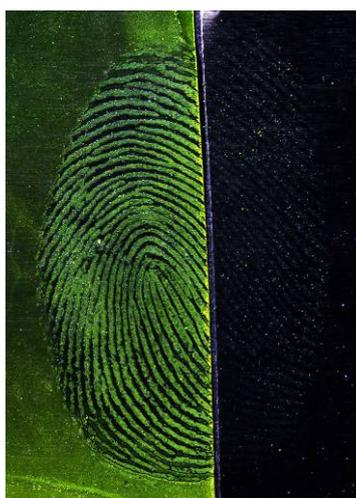
Figure 8-11 : Détection d'une trace non-sanglante sur aluminium avec une solution de CdTe-TGA activée avec EDC/NHS (gauche) et sans activation (droite).
