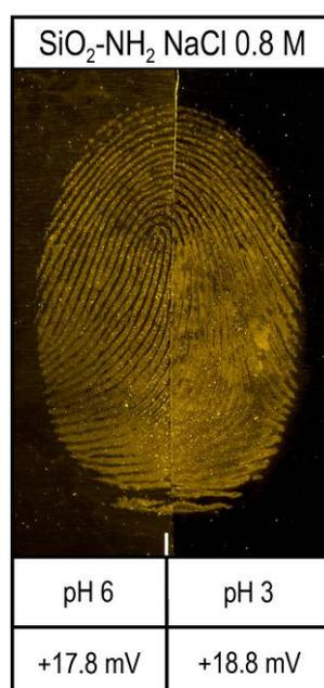
Figure 7-27 : Illustration de l'influence du pH sur la détection pour une solution de nanoparticules fonctionnalisées avec une amine primaire, contenant du NaCl. Visualisation en luminescence avec une excitation à 515 nm et une observation avec un filtre interférentiel à 590 nm.
