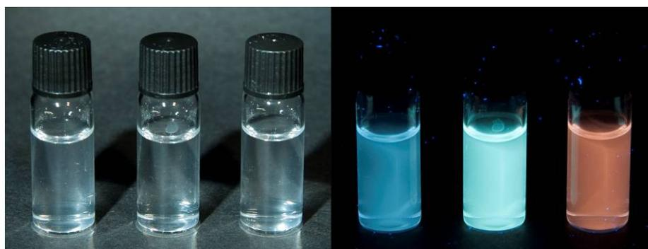
Figure 6-13 : Illustration de l'effet du dopage sur les propriétés de luminescence des *quantum dots* de ZnS. De gauche à droite sont visibles une solution de ZnS sans ion dopant, avec 1 % de cuivre et avec 4.5 % de manganèse. L'image de gauche est réalisée en lumière blanche et celle de droite sous UV (300-400 nm), sans filtre d'observation.
