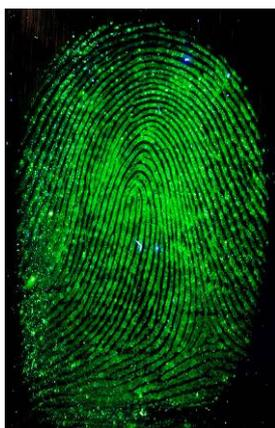
**Figure 6-21 :** Illustration d'une trace enrichie en sécrétion sébacée, détectée par immersion dans une solution de CdTe-TGA moins d'une heure après sa déposition sur une feuille d'aluminium. Le résultat est observé sous UV (300-400 nm), sans filtre d'observation.
