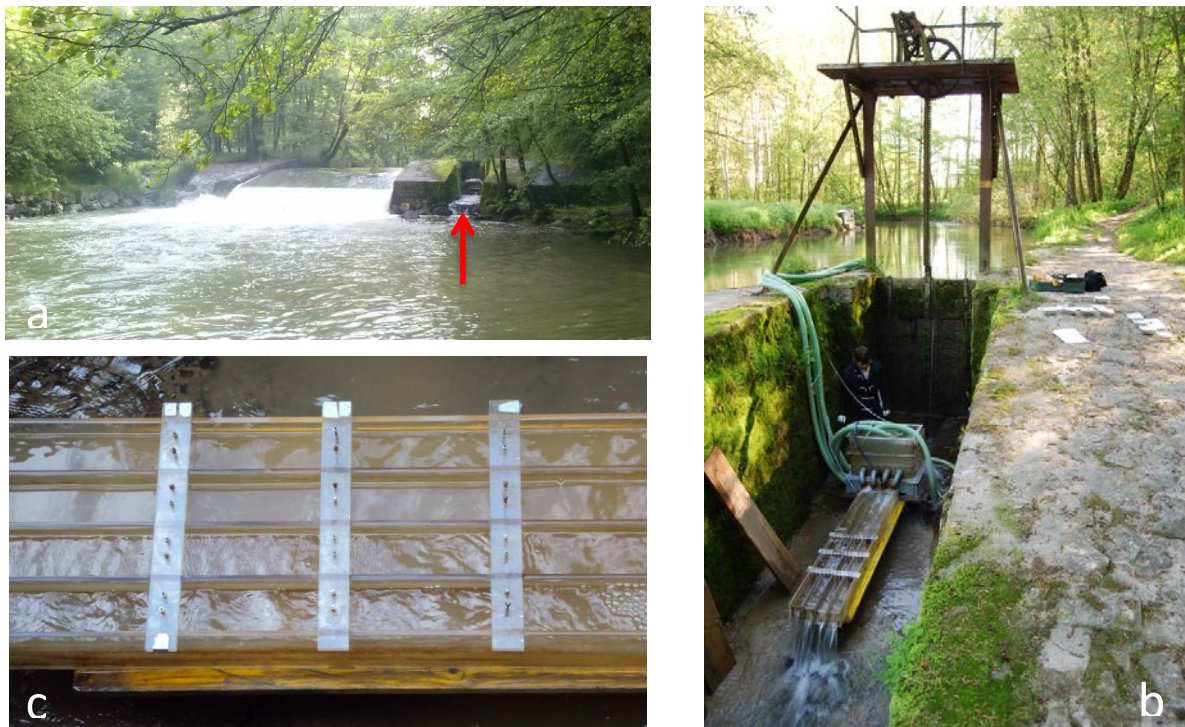
Figure 18 : Site de la Venoge où le système de canaux a été installé (a), système de siphon pour alimenter le système de canaux (b) et déploiement des capteurs dans les canaux (c).
