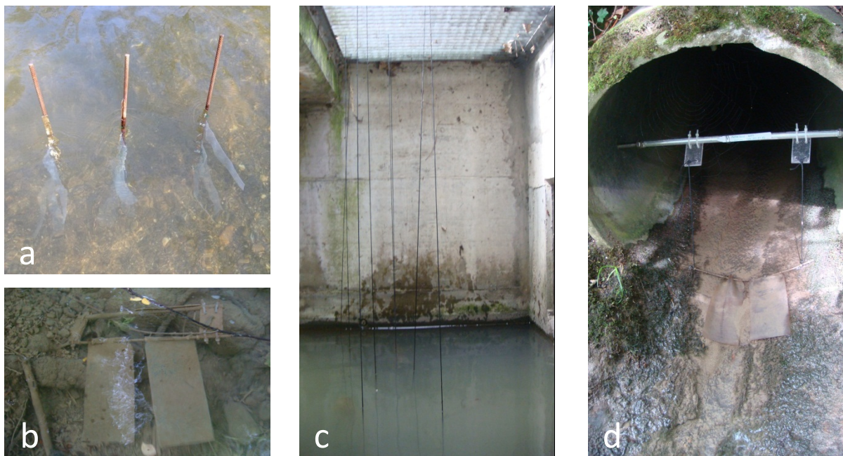
Figure 25 : Différentes possibilités de fixation des capteurs : fers à béton plantés verticalement dans le lit de la rivière (a), fer à béton planté à l'horizontal dans le lit d'un ruisseau (b), fers à béton suspendus par des cordelettes attachées à une grille (c) dispositif de fixation (cylindre + tiges filetées + écrous) pour l'intérieur de conduites (d).
