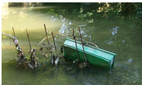
Figure 26 : Exemple d'objets pouvant percuter les capteurs (gauche) et fers à béton de protection (à droite).
