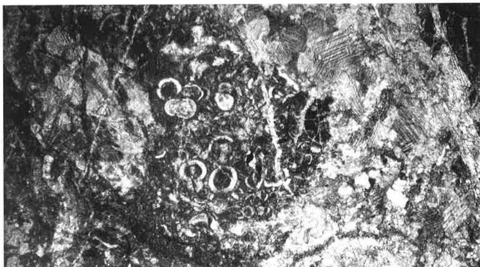
Figure 58. Lame-mince dans les calcaires de l'Unité de Salsipuedes montrant un assemblage de tests épais et largement perforés de foraminifères planctoniques probablement oligocènes et la recristallisation des calcaires (sparite à droite).
