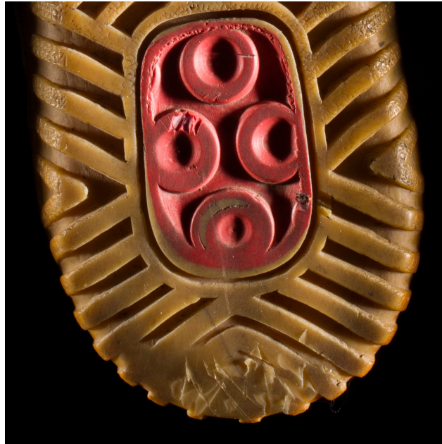
Figure 47 : Éclairage en lumière frissante d'une semelle permettant de mettre en évidence ses détails de surface pour en établir une description (repris des enseignements pratiques de l'ESC, 2012).
