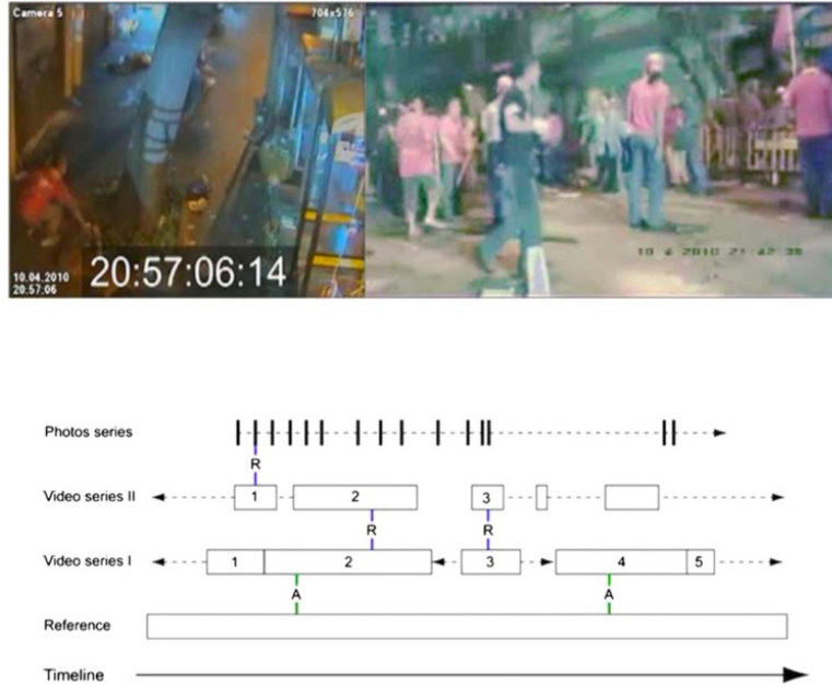
Figure 53 : Reconstitution d'événements violents en Thaïlande en 2010 (repris de Milliet, Delémont, et al., 2014: 115). Les sources distinctes présentant des points de vue différents d'une même scène sont synchronisées selon le schéma temporel présenté en dessous.
