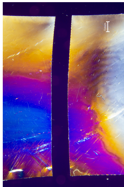
Figure 97: Photographie en double polarisation d'un assemblage de couleurs interférentielles de deux morceaux de plastique biréfringent. L'évaluation de la confiance en cet assemblage est plutôt qualitative bien que certains éléments quantitatifs puissent entrer en ligne de compte comme le nombre de couleurs différentes concordantes (photographie d'étudiant issue des travaux pratiques de photographie de l'ESC, 2018).
