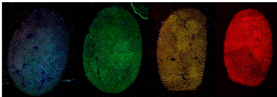
Figure 54 : Comparaison de la détection de traces papillaires à l'aide de nanoparticules de SiO 2 contenant des quantum dots de taille variable permettant de faire évoluer le maximum d'émission (repris de Moret, 2013: 171).
