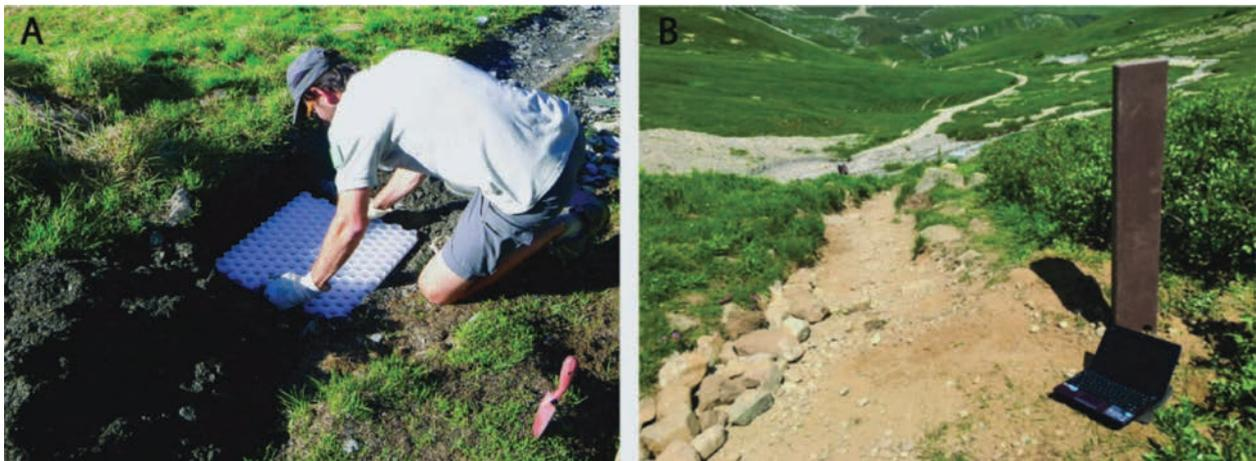
Figure 1 - Deux capteurs capables de mesurer la fréquentation de sentiers de montagne : (a) mise en place d'un capteur Dalle (photo V. Fourcaudot, ASTERS) ; (b) capteur Pyro (photo G. Garcel, ASTERS).
