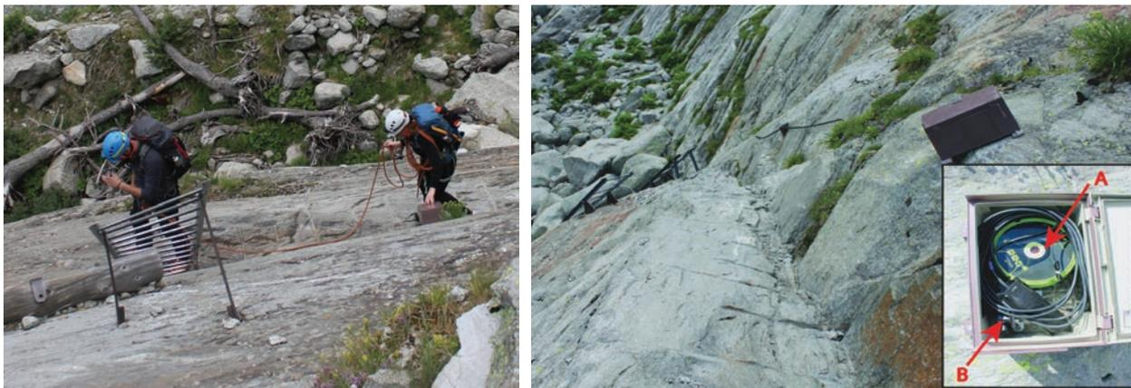
Figure 2 - Capteur Pyro sur l'accès à la Mer de Glace depuis le Montenvers. À droite : boîtier en plastique dans lequel l'Eco-Combo (a) et le capteur Pyro (b) ont été installés. Le boîtier constitue une protection efficace contre le soleil et le vandalisme.
