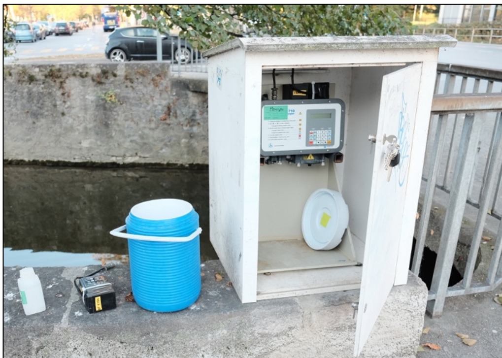
Figure 1: Site de prélèvement de la Direction Générale de l'Environnement du canton de Vaud (DGE) avec échantillonneur automatique, Morges, Suisse.
