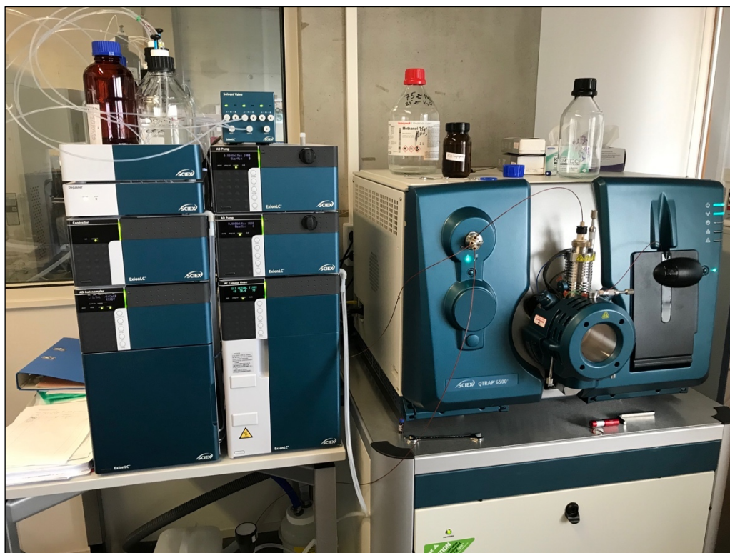
Figure 13: HPLC-MS/MS, AB Sciex QTRAP 6500+ utilisé pour quantifier les pesticides
