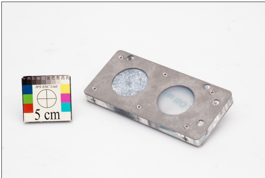
Figure 19: Support adapté avec plexiglas de 10mm d'épaisseur pour maintenir le disque d'alabaster (à gauche)
