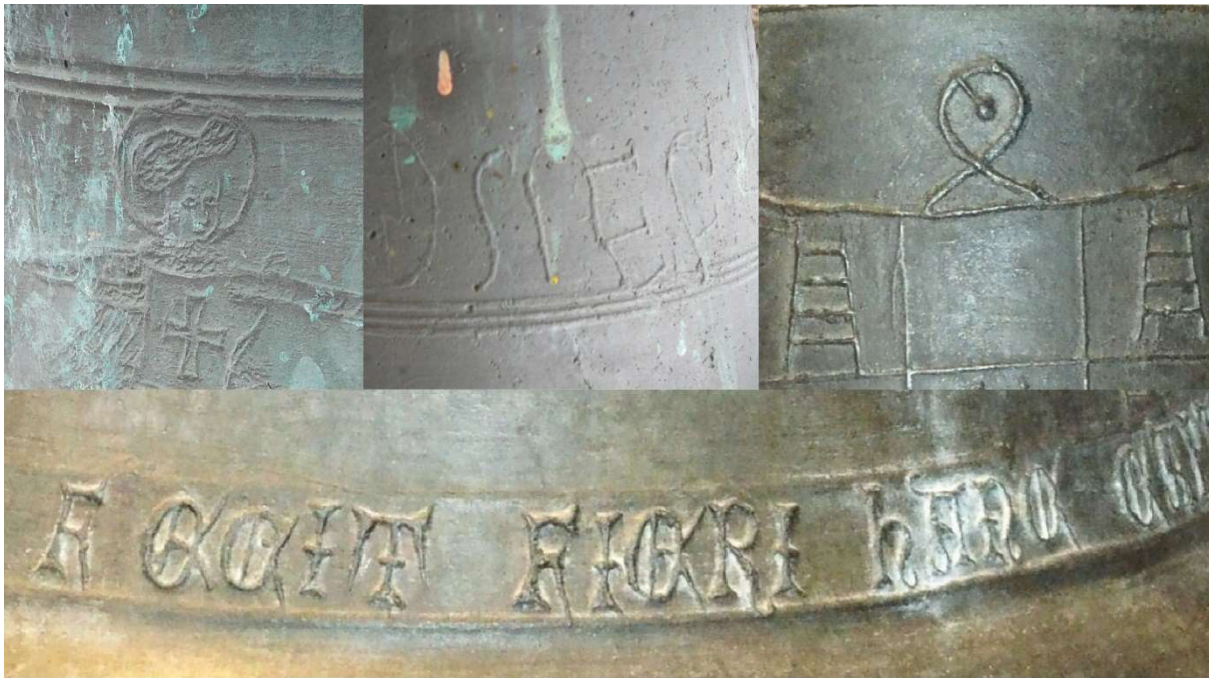
Fig 2. - Tratti sovrapposti in modo incompatibile con una realizzazione a graffito. In alto a sinistra: campana di Lostalzo (n° 10), aureola di S. Giorgio sovrapposta a una linea decorativa. In alto al centro: campana di Scona (n° 4), lettere sovrapposte alle linee decorative. In alto a destra: campana di Federico della Scala (n° 23), tratti sovrapposti nell'elemento superiore dello scudo del committente (foto: Matteo Padovani). In basso: campana di Pietro della Scala (n° 24), lettere con svolazzi sovrapposti alle linee decorative (foto: Matteo Padovani).
