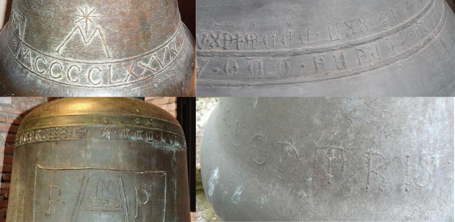
Fig. 1 - Tratti dalla forma incompatibile con una realizzazione a graffito. In alto a sinistra: campana di Luzzogno (n° 15), lettere dai tratti spessi e regolari. In alto a destra: campana della Torre del Gardello (n° 26), lettere di spessore variabile. In basso a sinistra: campana di Pietro della Scala (n° 24), scritta con punti di separazione tondeggianti e stemma dai tratti spessi e regolari (foto: Matteo Padovani). In basso a destra: campana di San Vittore (n° 2), punti tondeggianti all'estremità delle lettere.
