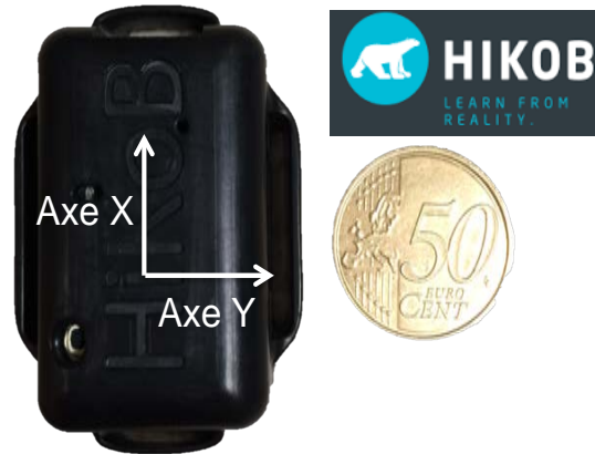
Figure 30. Photographie d'une centrale inertielle HIKOB FOX. (Pièce de 50cts d'euros –Ø 2,4 cm–pour l'échelle). L'orientation de la centrale est également présentée (l'axe Z, non représenté sur cette photographie en deux dimensions, traverse la centrale de façon transversale).
