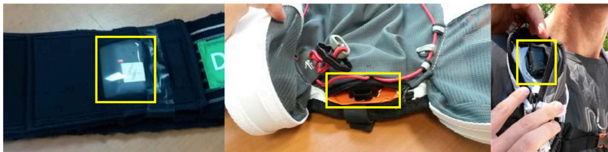
Figure 29. Illustrations des emplacements des capteurs. La photographie sur la gauche représente la ceinture que les participants portaient au niveau des hanches. La photographie du milieu montre l'emplacement de la centrale inertielle au fond du sac. Celle de droite montre l'emplacement de la centrale au niveau des bretelles du sac.
