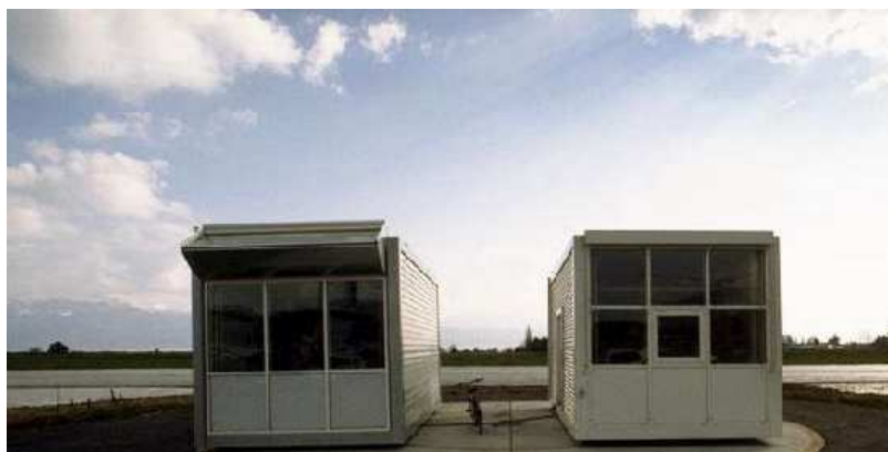
Figure 3.19 Locaux prototypes, celui de gauche sur la photographie a été totalement obscurci pour des tests visuels de référence, celui de droite était celui utilisé pour l'expérience en elle-même.
