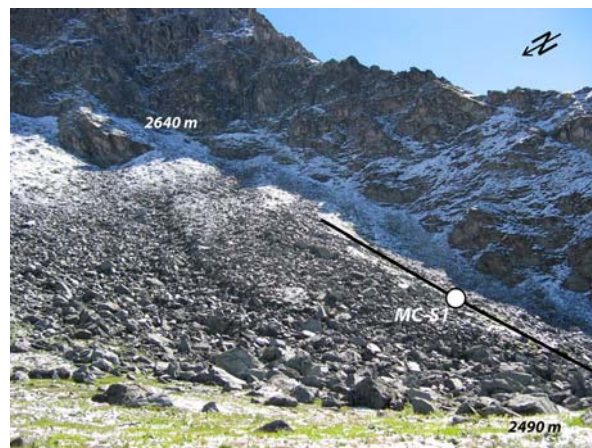
Fig. 3.96. Vue sur l'éboulis fluant des Monts de Cion, avec la position du sondage géoélectrique.
