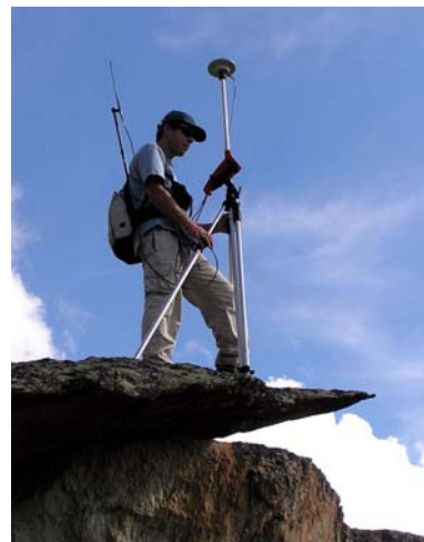
Fig. 2.8. A gauche: station de référence, vallon des Yettes Condjà. Photo: R. Monnet. A droite: mesure d'un point à l'aide du récepteur mobile. Photo: R. Delaloye.
