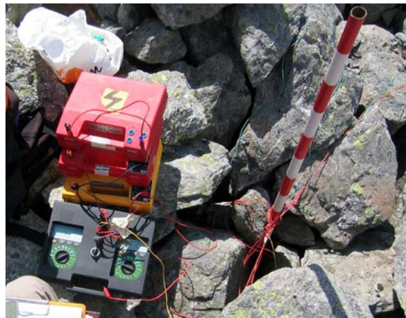
Fig. 2.5. Appareil utilisé pour la prospection électrique. Ici, 3 mallettes de 90V chacune sont utilisées comme source d'énergie. On distingue au bas de l'image les deux multimètres digitaux. Photo: G. Cheseaux.
