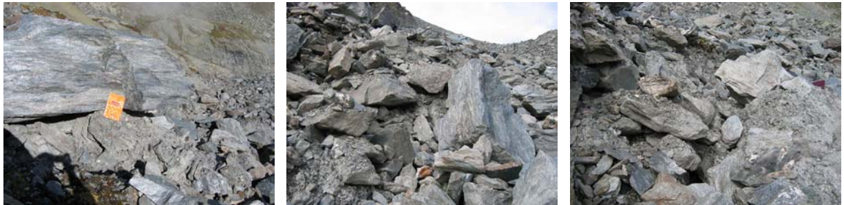
Fig. 4.24. Signes d'instabilités très marqués sur le glacier rocheux B, au sommet de la pente raide (localisation sur Fig. 4.25). On distingue sur les trois photos la présence de fines à la surface du glacier rocheux. Au centre de la photo de droite apparaît une crevasse, signe d'une perturbation de la dynamique du glacier rocheux.
