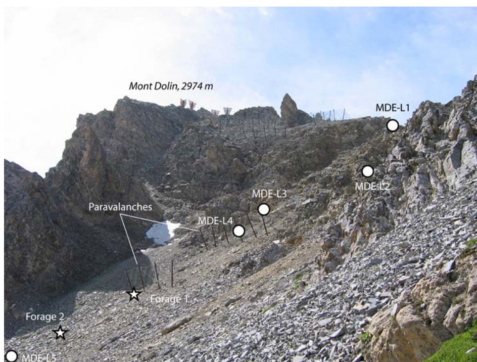
Fig. 3.136. Portion sommitale de l'éboulis du Mont Dolin, avec la position des deux forages et des cinq mini-loggers.
