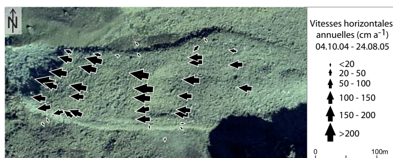
Fig. 4.45. Vitesses horizontales de surface sur le glacier rocheux de Tsarminne, calculées selon les déplacements d'octobre 2004 à août 2005. Reproduit avec l'autorisation de Swisstopo (DV023268).
