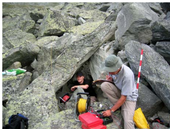
Fig. 2.6. Aperçu des conditions de mesure lors de la réalisation d'un sondage géoélectrique sur un glacier rocheux dont la surface est exclusivement constituée de gros blocs (glacier rocheux de Tsarmine). Photo: J. Comby.
