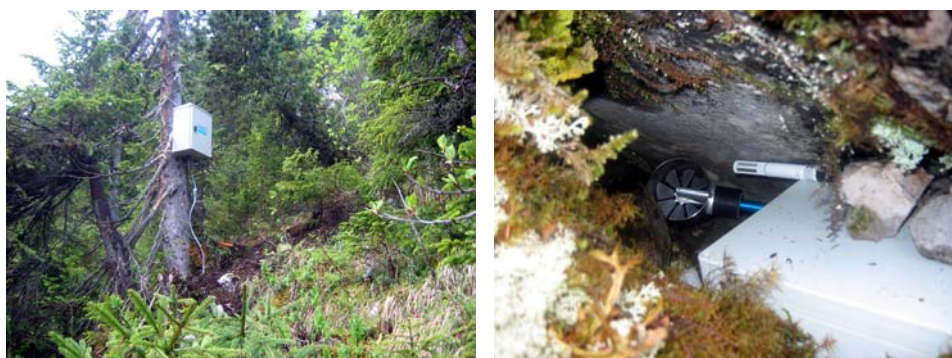
Fig. 3.6. A gauche: emplacement du forage 1, dans la partie médiane de l'éboulis, avec la station MADD. Photo prise depuis le chemin visible sur la Fig. 3.4. A droite: l'anémomètre et le capteur d'humidité de l'air, placés dans une cavité de la partie aval de l'éboulis.
