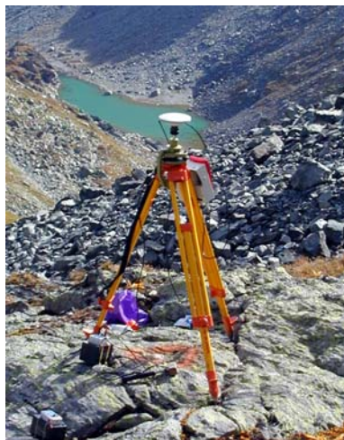
Fig. 2.8. A gauche: station de référence, vallon des Yettes Condjà. Photo: R. Monnet. A droite: mesure d'un point à l'aide du récepteur mobile. Photo: R. Delaloye.
