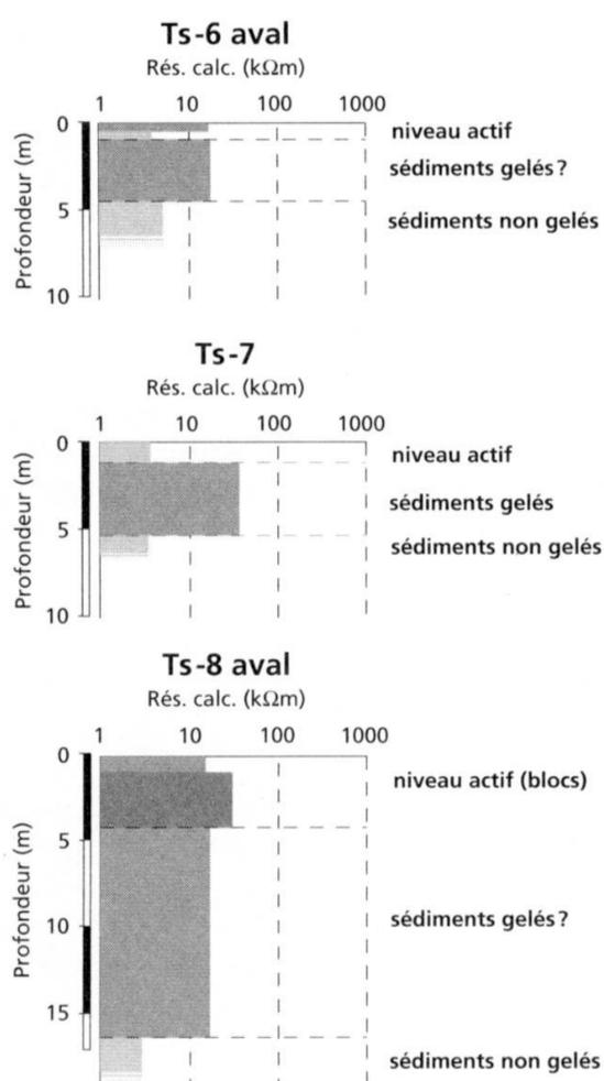
FIGURE 15 – Sondages géoélectriques réalisés sur l'éboulis de Perroc.
