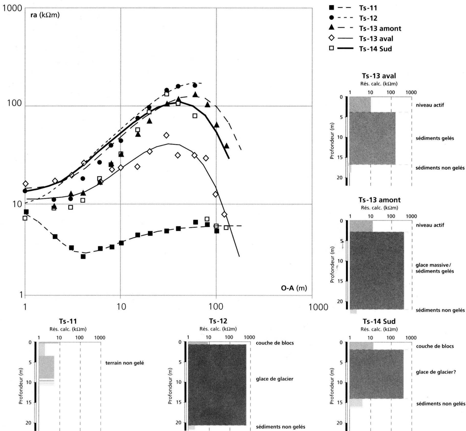
FIGURE 13 – Sondages géoélectriques réalisés sur le complexe glacier-glacier rocheux de Tsarmine.
