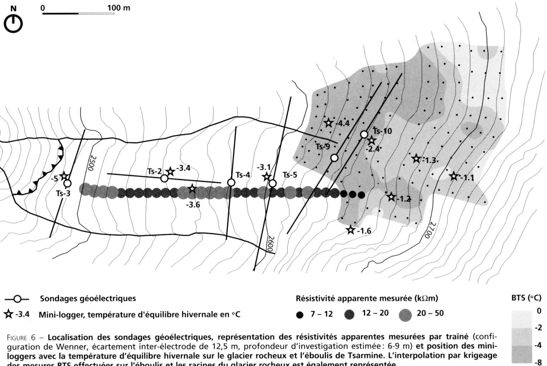
FIGURE 6 – Localisation des sondages géoélectriques, représentation des résistivités apparentes mesurées par traîné (configuration de Wenner, écartement inter-électrode de 12,5 m, profondeur d'investigation estimée: 6-9 m) et position des mini-loggers avec la température d'équilibre hivernale sur le glacier rocheux et l'éboulis de Tsarmine. L'interpolation par krigeage des mesures BTS effectuées sur l'éboulis et les racines du glacier rocheux est également représentée.
