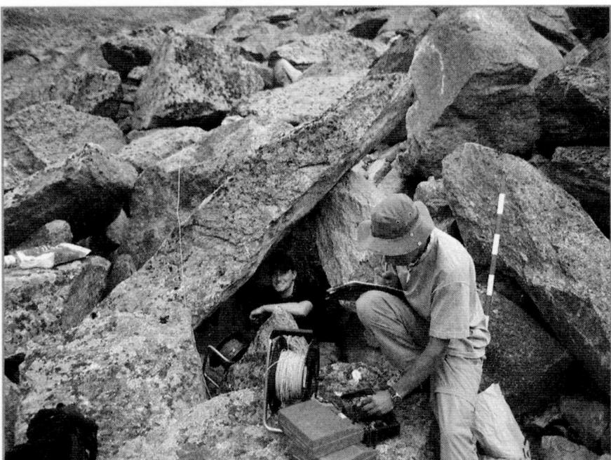
FIGURE 7 – Aperçu des conditions de mesures pour la prospection géoélectrique. Ici le centre du sondage Ts-3. – PHOTO JACQUES COMBY
