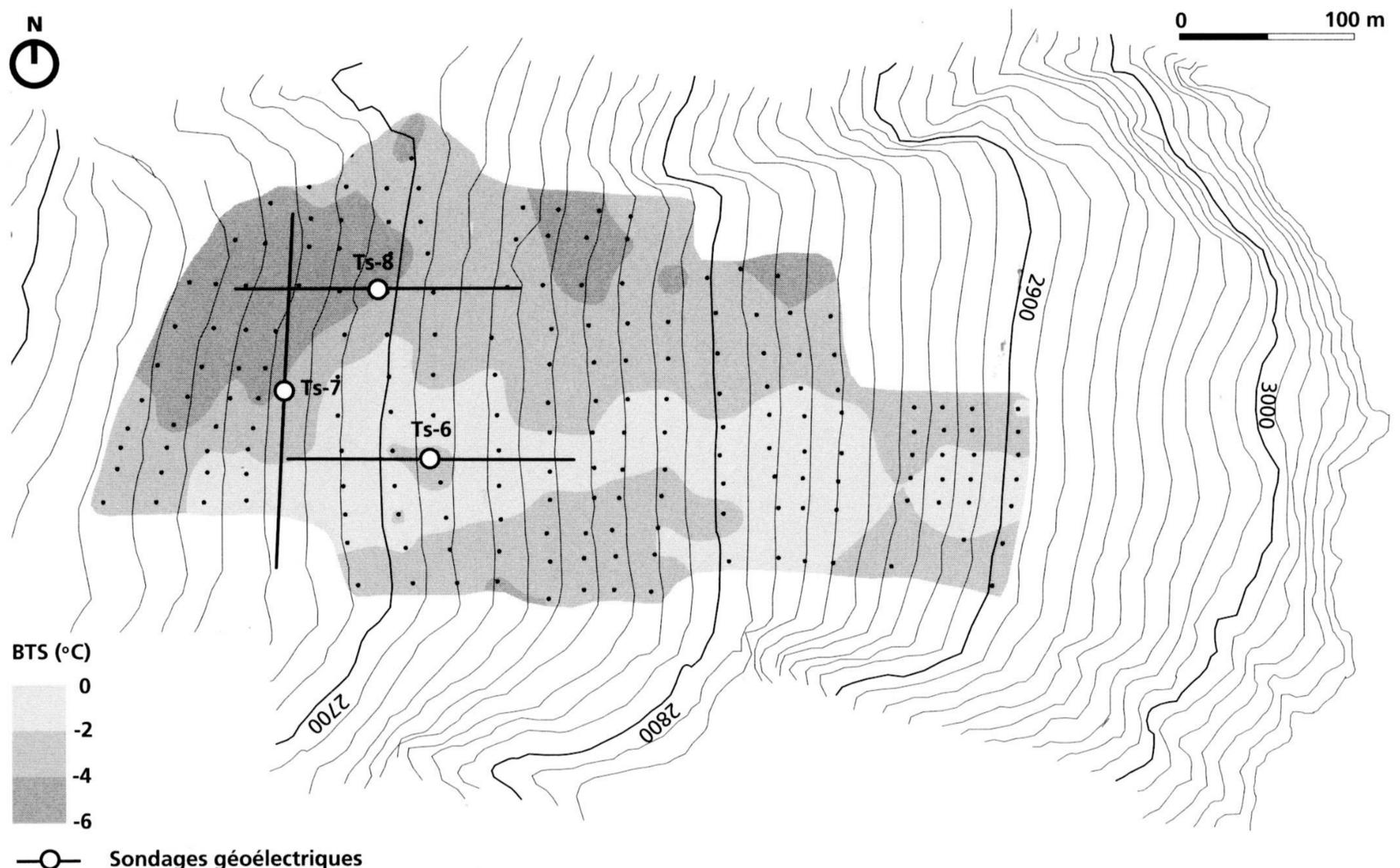
FIGURE 14 – Localisation des sondages géoélectriques et interpolation des mesures BTS effectués sur l'éboulis de Perroc.
