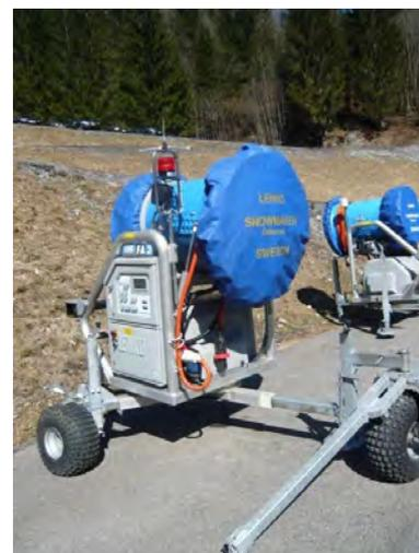
Les systèmes monofluides sont appelés ainsi car ils ne nécessitent que l'arrivée d'un seul fluide, l'eau sous pression, l'air étant fourni par un ventilateur. Ces enneigeurs sont en règle générale montés sur des supports mobiles (châssis avec roues ou luge). Ils peuvent être également implantés en hauteur sur des mâts de 4 à 6 mètres ou sur des bras articulés. Leur fonctionnement peut être manuel, autonome (automatisme embarqué) ou dépendant d'un système de gestion centralisé.
