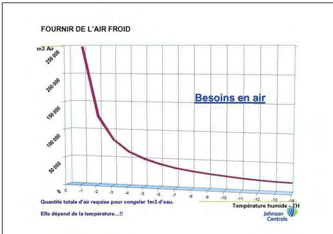
*Les besoins en air sous pression varient fortement en fonction de la température humide de l'air ambiant.*
