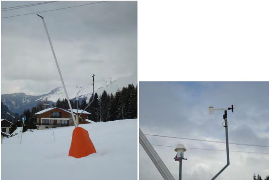
*Cette station intégrée au canon mesure la température de l'air, le taux hygrométrique, la vitesse et la direction du vent.*
