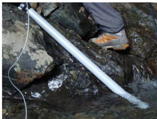
Les jaugeages au sel ont été réalisés ponctuellement avec des mesures étalées sur les trois années d'études de 2010 à 2013. Il était particulièrement important d'effectuer ces mesures dans des conditions d'écoulement différentes (période de
