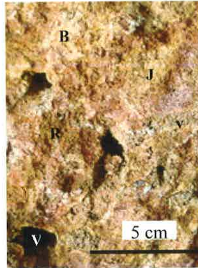
Figure A.3 : Photo du faciès carapace massive bariolée. v : veine, V : vacuole, R : matériau ferrugineux rouge très consistant, J : matériau jaune, B : matériau blanchâtre.
