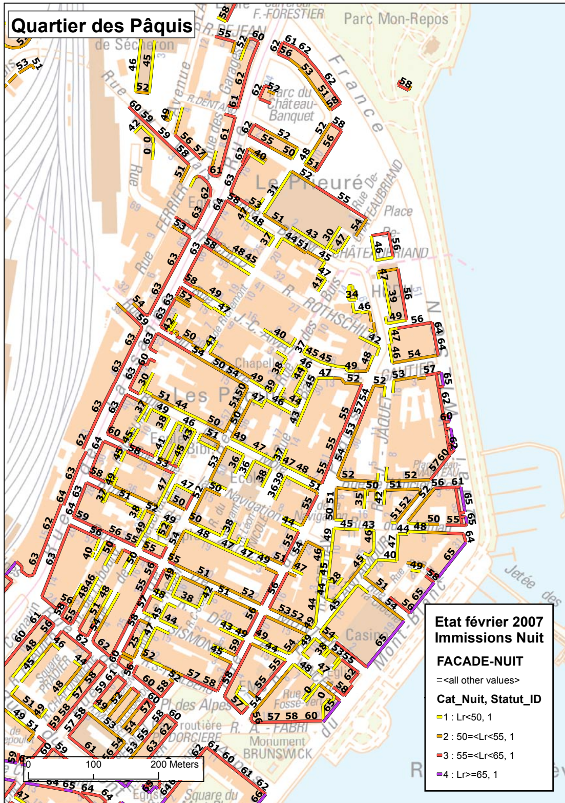
Figure 15b: Cadastre des immissions actuelles (2009) de nuit. Encore de nombreux dépassent les VLI, mais d'uniquement 1 à 2 dB (A), contre 4 à 8 avant assainissement. Source : SITG.
