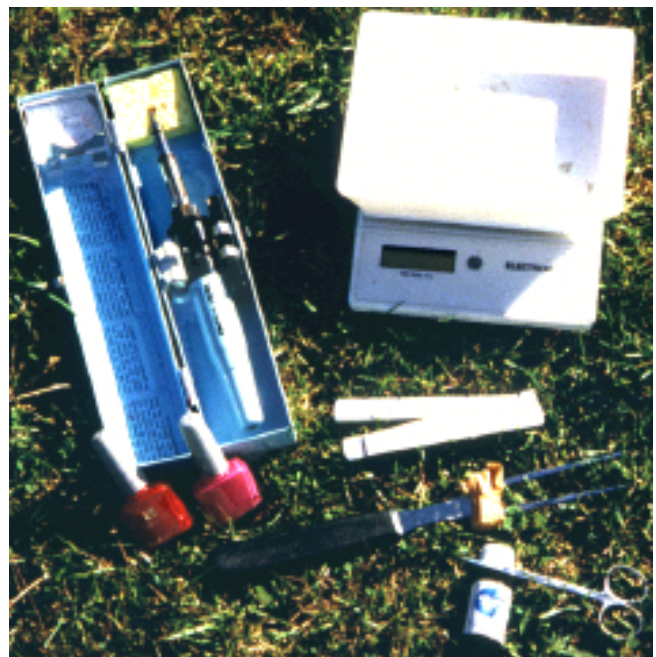
Figure 6: Matériel utilisé: (de gauche à droite) fer à souder (marquage à chaud), vernis à ongles (marquage temporaire), pique à viande modifiée, mètre, balance électronique, ciseaux (coupures d'écaillés) et désinfectant (cf. chap. 4.1).
