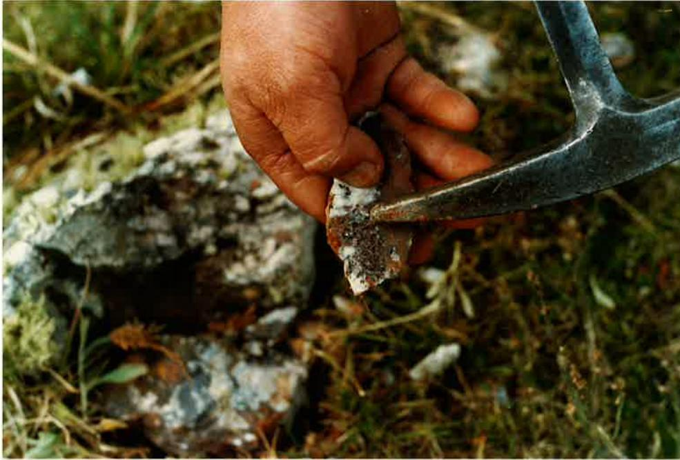
FOTO 5: Textura típica de un sombrero de hierro altamente silicificado desarrollado sobre una mineralización de sulfuros de cobre.
