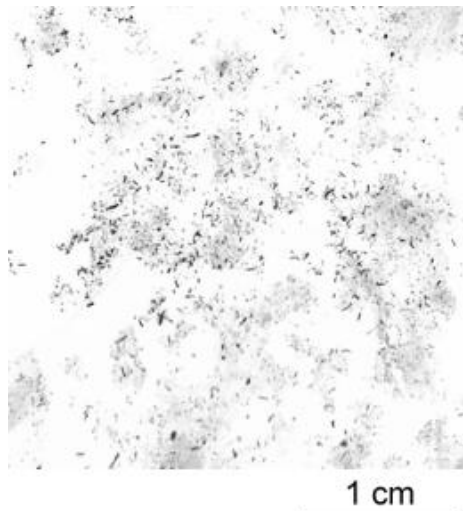
Figure 163 : Particules de la trace du pneumatique N°1, déposées lors du freinage d'urgence avec le système de freins anti-bloquants enclenché
