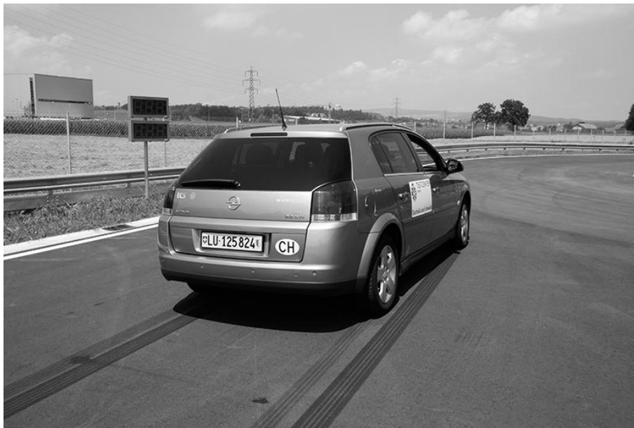
Figure 160 : Traces de pneumatiques sur la chaussée, déposées lors du freinage d'urgence avec le système de freins anti-bloquants déconnecté
