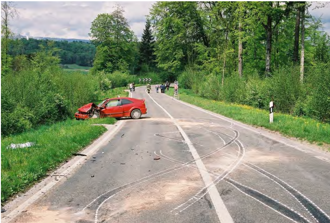
Figure 9 : Traces de dérapage (source : Service Technique des Accidents de la Police Cantonale Bernoise)
