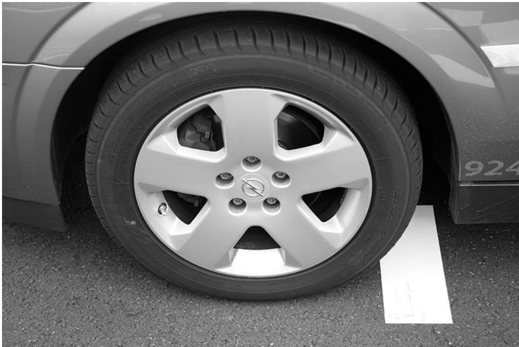
Figure 153 : Positionnement de la feuille de gélatine pour le prélèvement de la trace de pneumatique
