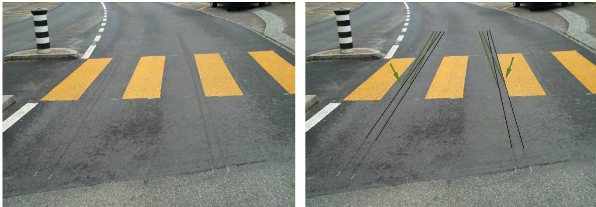
Figure 11 : Traces de déviation avec, à droite, une illustration de la déviation due à un impact au niveau du passage piéton (flèches vertes) (source : Service Technique des Accidents de la Police Cantonale Bernoise)
