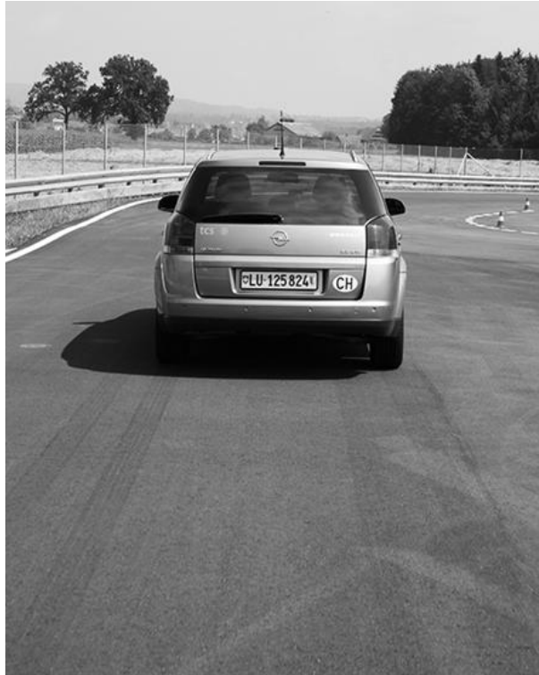
Figure 156 : Traces de pneumatiques continues sur la chaussée
