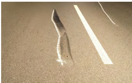
Figure 10 : Trace de pression (source : Service Technique des Accidents de la Police Cantonale Bernoise)
