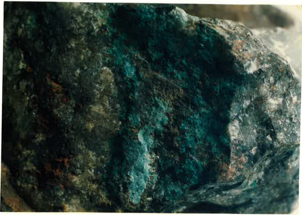
FOTO 7: Irización azul de la covelina, clásica en la alteración de la calcocina (OM 9006).
